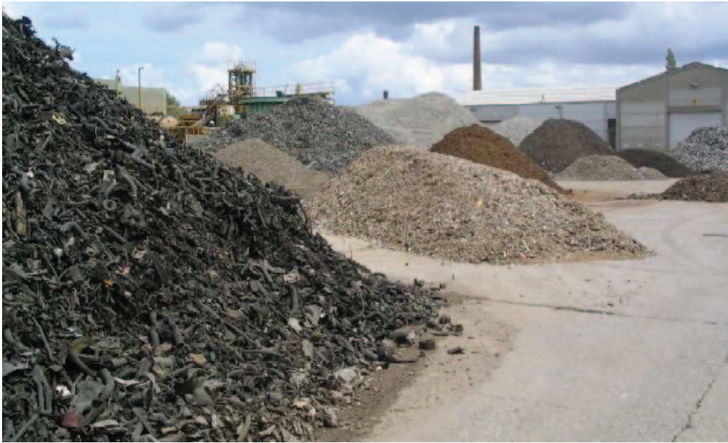
Figure 25 : Fractions de résidu de broyage en cours de séparation (Opérateur : Galloo Metal, Halluin)
