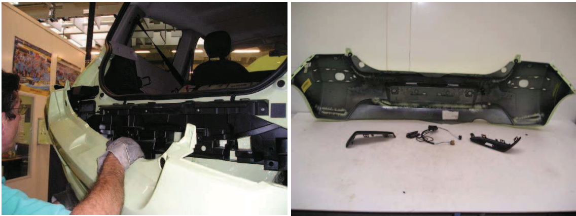
Figure 22 : Opération de démontage et exemples de pièces pouvant être extraites (Bouclier arrière, Source RENAULT)
