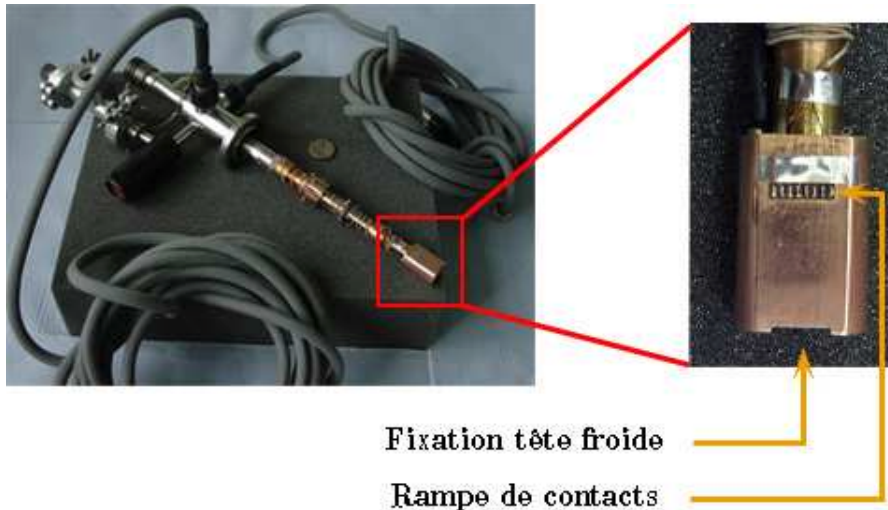
FIGURE 5.4 – (a) Vue d'ensemble de la canne Oxford Instrument Microstat He. Les deux faisceaux de câble relient le cryostat aux instruments de mesure et de contrôle. (b) Extrémité de la canne, les rampes de contacts sont ici en cours d'installation.
