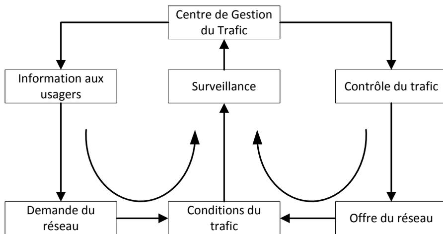
Fig. 3-5 : Schéma des actions de l'exploitation du trafic
