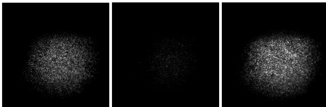
FIGURE 4.3 – Images d'un échantillon de Bodipy-Fl prises successivement (sur des zones différentes) avant injection de GODCAT (gauche), avec GODCAT (milieu) et après rinçage du GODCAT avec un tampon tris salé (droite). L'appauvrissement en oxygène conduit à une diminution du signal de fluorescence (milieu) que l'on restaure en réoxygénant (droite). Durée d'acquisition : 100 ms. Intensité moyenne du faisceau incident I = 400 \text{ W/cm}^2 @ 488 \text{ nm} .
