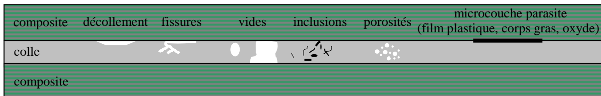
Figure I-19 : Schéma des principaux défauts dans les assemblages collés [Adams 1988].
