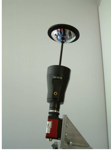
FIG. 3.2 – Caméra omnidirectionnelle catadioptrique.
