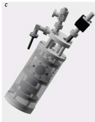
2. L'EXPÉRIENCE EMBARQUÉE dans l'Airbus ZERO-6 pour tester le principe d'équivalence occupe une bonne partie de l'avion (a). Les physiciens travaillent à la rendre plus compacte (b), leur objectif étant de la contenir dans un boîtier transportable de la taille d'une malle (c), afin de l'envoyer dans l'espace à bord d'un satellite.
