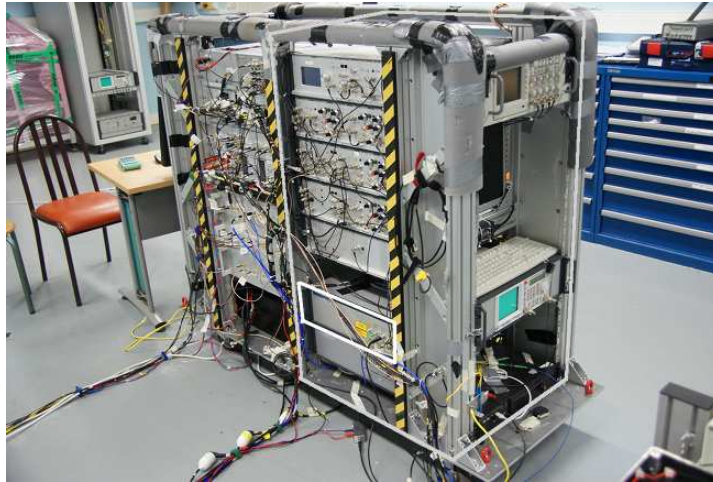
Figure 3.16 Peigne de fréquences installé sur l'expérience (Bâti 2). Il occupe toute la partie droite du bâti (encadrée en gris clair). L'optique est contenue dans le rack encadré en blanc (oscillateur femtoseconde, amplificateur, interféromètre f - 2f ). Le reste du dispositif comprend l'électronique de contrôle des diodes de pompe (en dessous du rack avec le laser) et toute l'électronique d'asservissement (partie la plus volumineuse) ainsi que l'ordinateur permettant de régler et enregistrer tous les paramètres (à droite).
