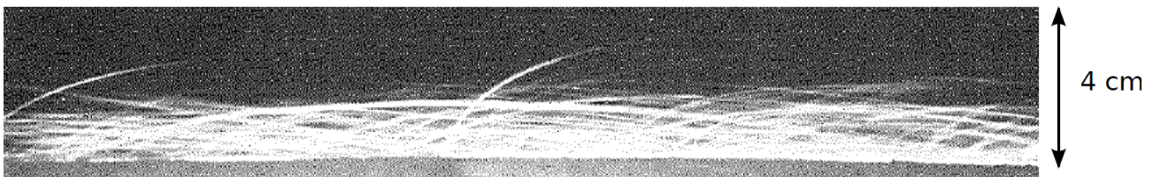
FIGURE 1.4 – Exemples de trajectoires de particules de neige en saltation ( U_{1m} = 5 \text{ m s}^{-1} ). Image tirée de Kobayashi (1972).
