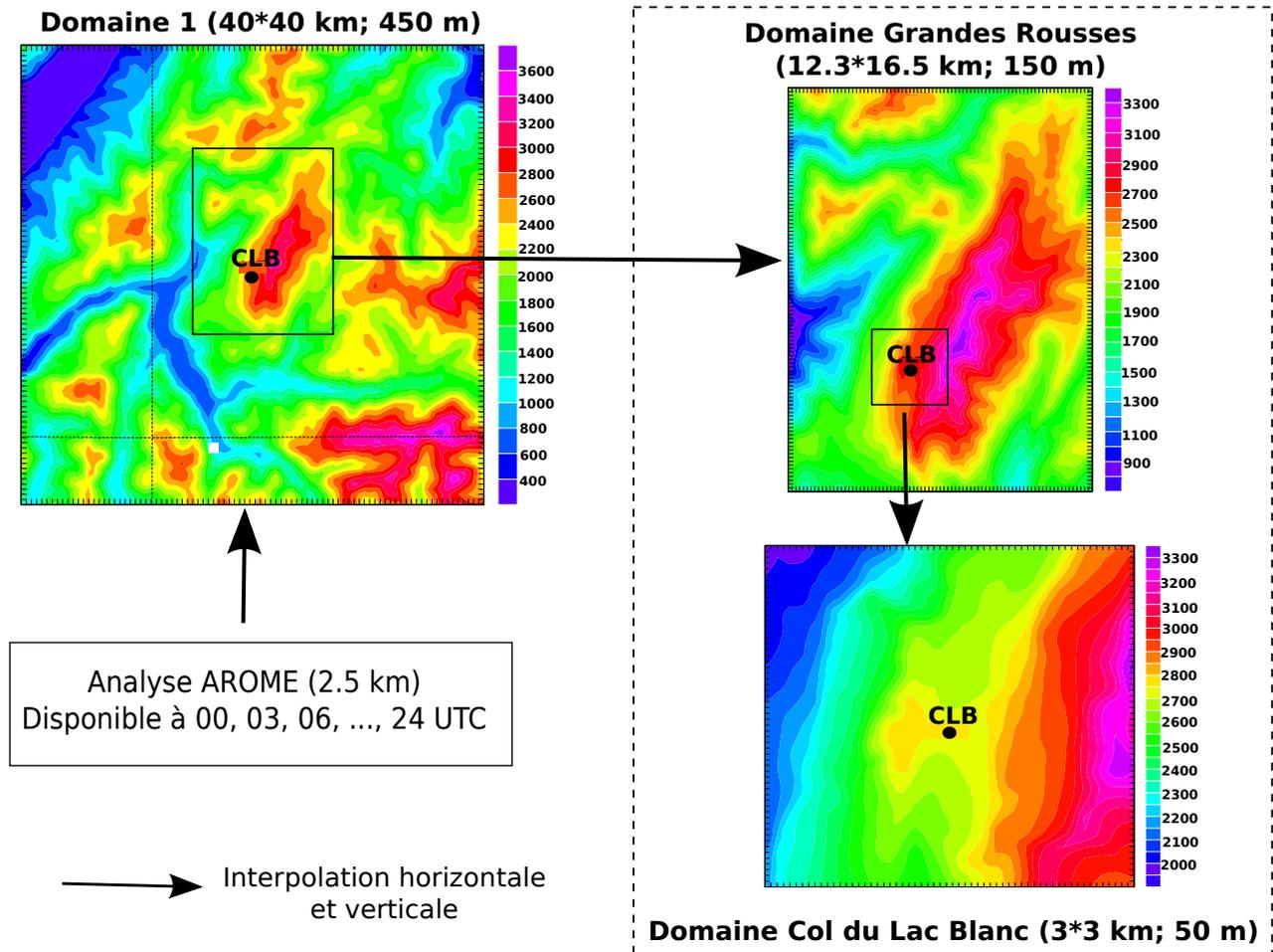
**FIGURE 7.1** – Principe de fonctionnement de la descente d'échelle sur la site expérimental du Col du Lac Blanc. Le cadre en pointillé désigne les domaines sur lesquels les simulations de transport de neige par le vent seront effectuées.
