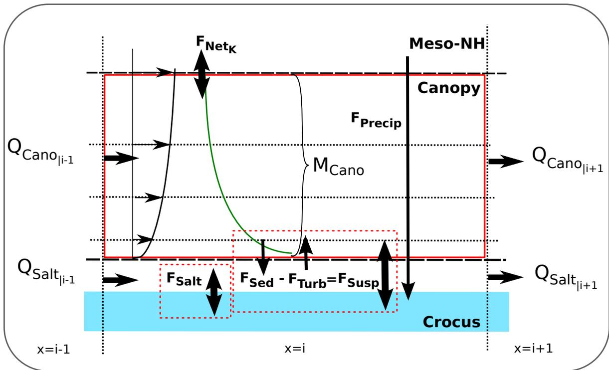
**FIGURE 5.4** – Schéma des échanges de masse entre les différentes composantes du modèle Meso-NH/Crocus. Le modèle tient compte des contributions du transport en saltation ( $F_{\text{Salt}}$ ), en suspension turbulente ( $F_{\text{Susp}}$ ) et de la précipitation neigeuse ( $F_{\text{Precip}}$ ).  $x$  désigne la coordonnée suivant un axe orienté dans le sens du vent.
