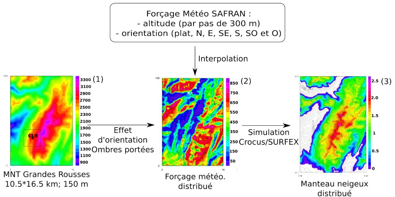
**FIGURE 7.2** – Principe de fonctionnement de la simulation distribuée sur la massif des Grandes Rousses : (1) MNT des Grandes Rousses (150 m). CLB indique la position du Col du Lac Blanc. (2) Rayonnement solaire incident (diffus+direct,  $W m^{-2}$ ) simulé le 18/02/2011 à 10h. (3) Hauteur de neige (m) le 15/04/2011 à 06h.
