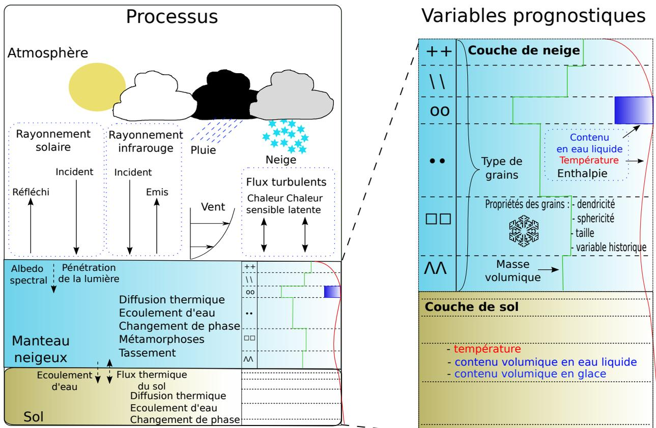
FIGURE 2.1 – Variables d'état du modèle Crocus et principaux processus physiques simulés
