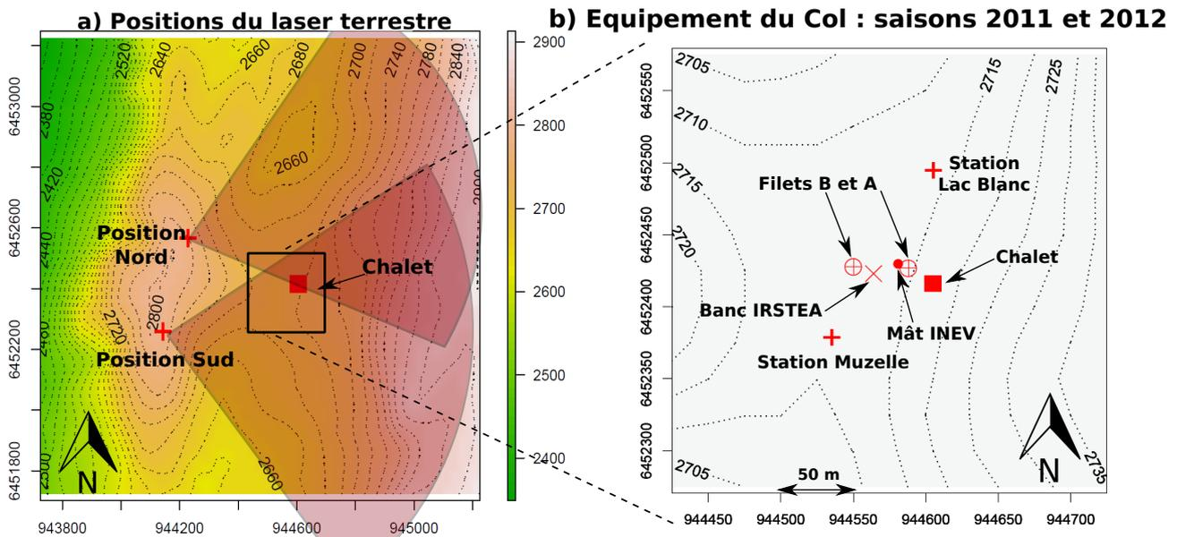
**FIGURE 4.1** – Cartes du dispositif expérimental installé au Col du Lac Blanc lors des deux campagnes de mesures. La carte (a) montre approximativement les zones couvertes par le laser terrestre depuis chaque position d'utilisation. Les effets d'ombres induit par le relief ne sont pas pris en compte.
