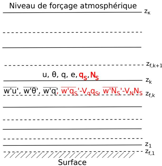
**FIGURE 5.5** – Discrétisation verticale de la CLS dans le modèle Canopy. Les traits pleins désignent les niveaux de masse où l'évolution des variables pronostiques est calculée alors que les traits tiretés désignent les niveaux où sont calculés les flux. Les variables en rouge représentent les variables relatives à la neige en suspension introduites dans le cadre de cette thèse.
