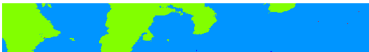
Figure 2.26: Échantillon T3-9. Segmentation de l'aragonite et de la calcite en dehors du masque associé à la porosité (en bleu ciel) à l'aide de l'équation du test 2.9. Sur cet exemple pris dans une zone bien préservée, seuls quelques pixels correspondent à de la calcite (en rouge). L'aragonite est en vert. Porosité : 71.30%. Aragonite : 28.69%. Calcite : 0.01%. \frac{\text{Calcite}}{\text{Aragonite} + \text{Calcite}} : 0.04%. La Fig. 2.27 illustre juste un autre exemple où une fraction très importante de calcite est cette fois identifiée avec un protocole strictement identique.
