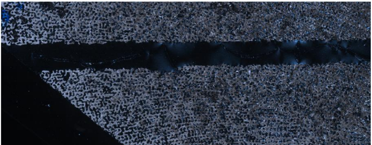
Figure 2.17 : Observation en lumière polarisée analysée (LNPA ; grossissement x50) d'une partie de la lame mince représentée Fig. 2.16. La résine amorphe apparaît en noir. Le squelette corallien apparaît avec des teintes grisées.
