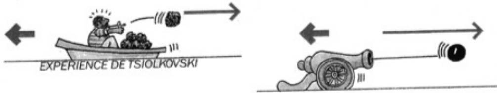
FIGURE 1.2 – Illustration de la poussée et du principe de Tsiolkovsky dans le cas horizontal avec des projectiles solides.
