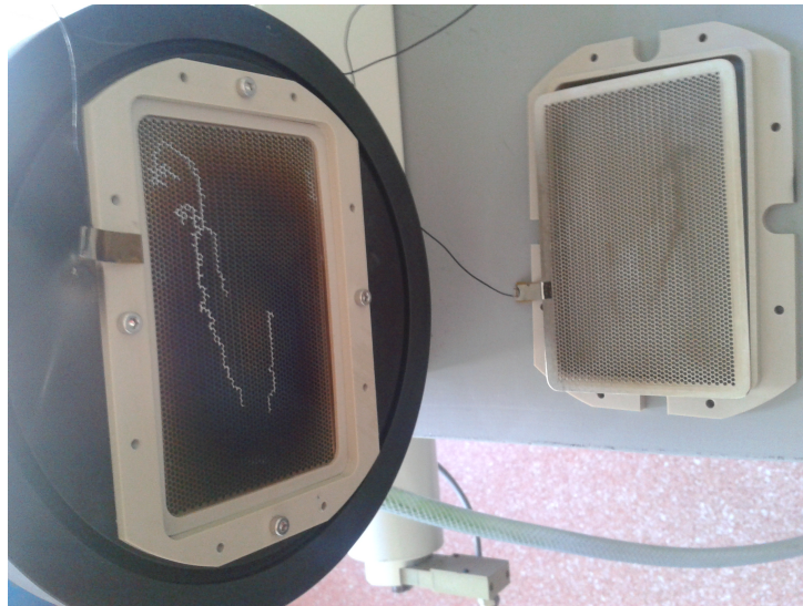
FIGURE 1.11 – Vue de la face arrière de la grille plasma et de la face avant de la grille d'accélération dans le cas de grilles.
