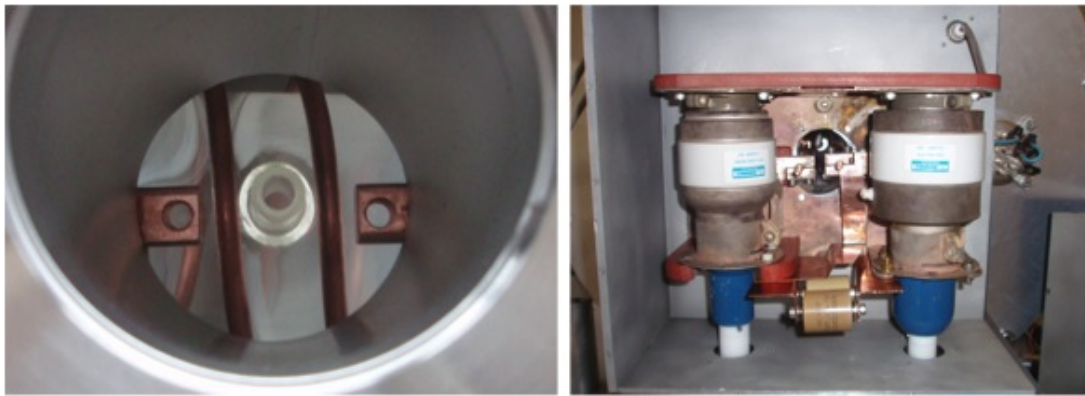
FIGURE 4.3 – A gauche : bobine d'induction entourant le cylindre de quartz et tube d'injection de gaz du premier prototype. A droite : boîte d'accord au premier plan, tiges de cuivre et bobine en arrière plan.
