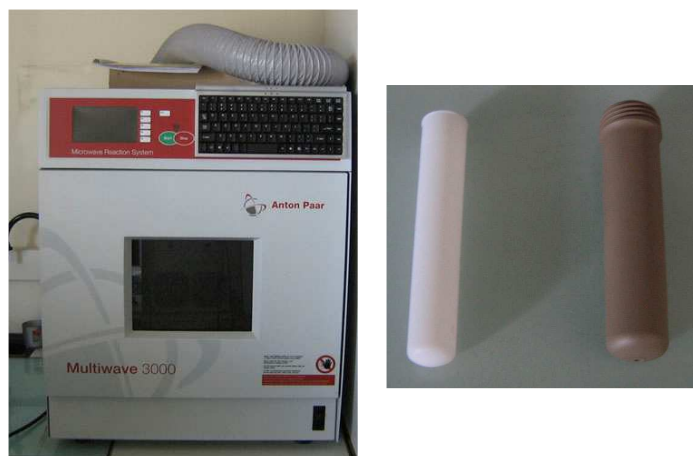
Figure II-12 : Multiwave 3000 et bombe Téflon pour micro-onde.
