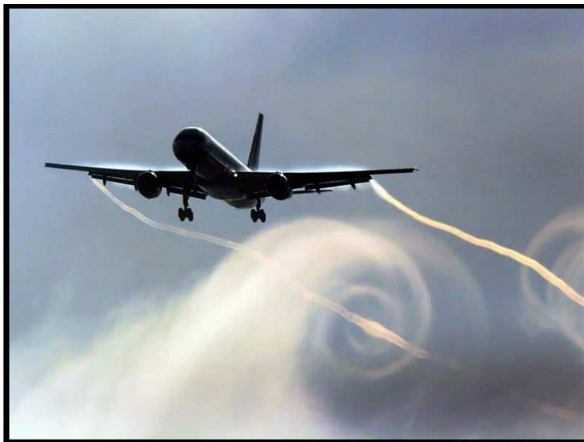
Figure 1 – Observation des tourbillons de sillage en bout d’aile (vortex).
