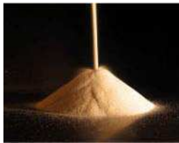
Figure 9.2 – Illustration d'écoulement de sable formant un tas dont l'angle de talus est égal à 35^\circ environ [Duran, 1997].
