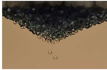
Figure 9.3 – Photo de capsules formant un tas dont l’angle de talus est environ égal à 35^\circ . Les capsules composées d’un cœur huileux remontent sous l’effet de la poussée d’Archimède.
