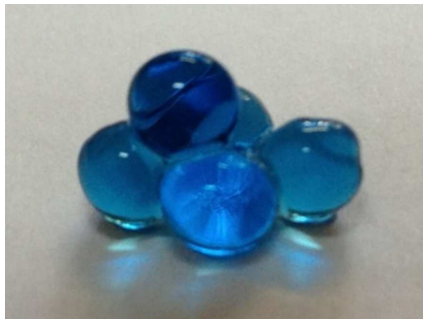
Figure 2.8 – Photo de capsules constituées d'une membrane fine d'alginate et d'un cœur huileux.
