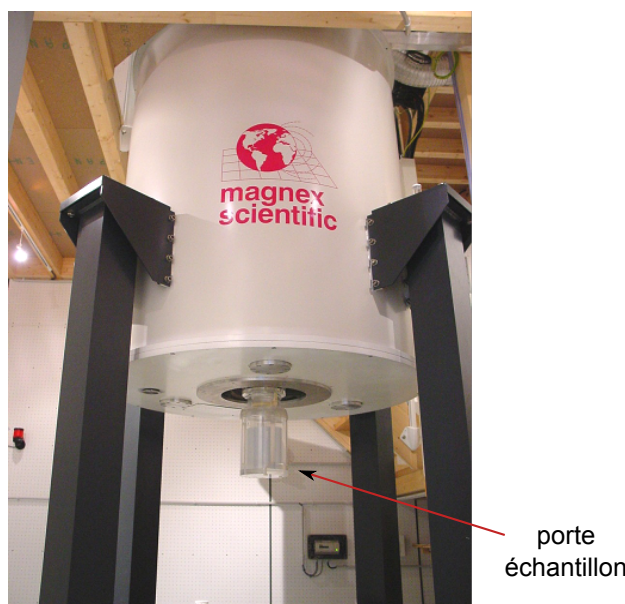
FIGURE 2.19 – Photographie de l'IRM et le porte échantillon IRM.
