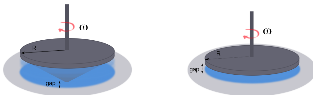
FIGURE 2.11 – Principe de la mesure de rhéométrie avec les géométries cône/plan (à gauche) et plan/plan (à droite).
