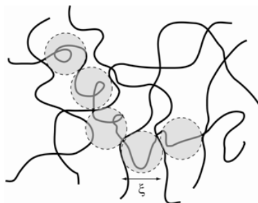
FIGURE 3.16 – Longueur d'enchevêtrement pour un réseau enchevêtré de polymère.
