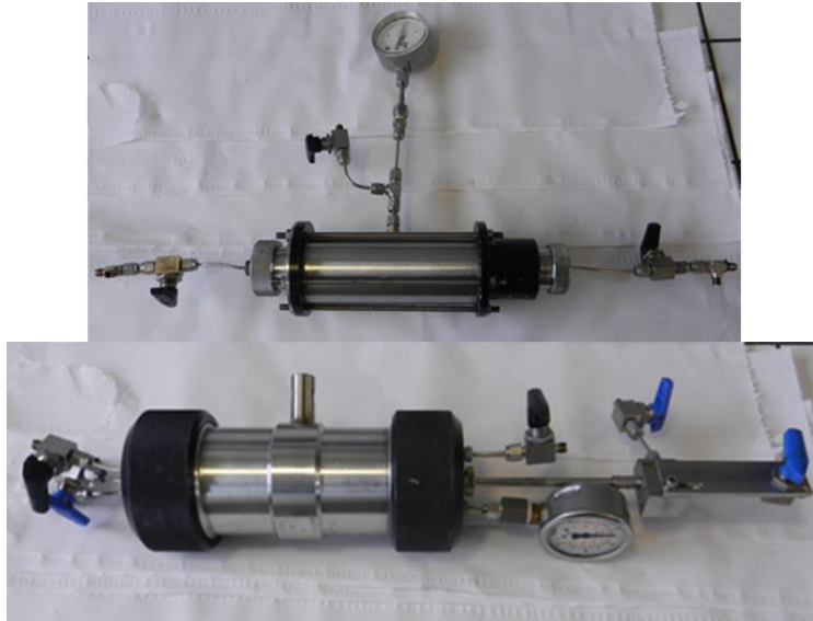
Figure 41: Montage des échantillons cylindriques dans les cellules type Hassler
