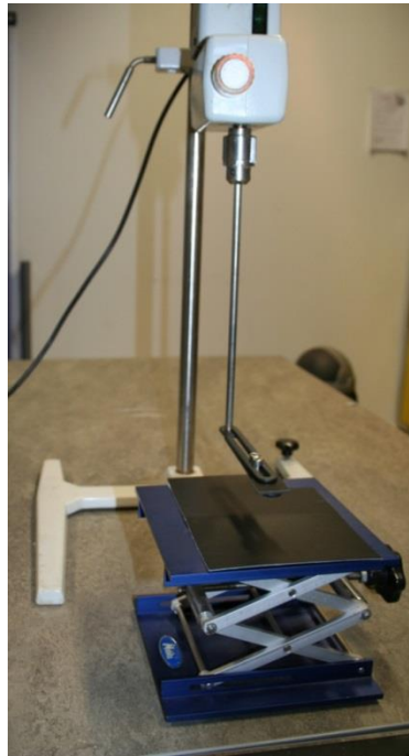
Photo 5-2 : Photo du système motorisé pour donner une vitesse définie à l'échantillon qui passe au-dessus d'un tapis fixe de convoyeur situé à 2mm en dessous de l'échantillon
