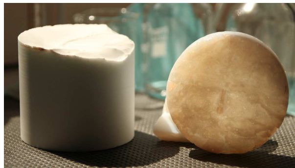
FIGURE 2.2 – Photographie de deux verres après la synthèse. À gauche une carotte de verre vba , à droite une tranche de verre Phase Si , dont on voit les inhomogénéités en transparence.
