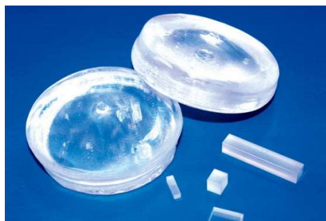
Figure IV-9 : Photo d'une boule de beta-BBO fabriqué par TGSS (source : Cryslaser.inc)
