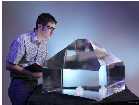
Figure II-9: Photo d'un cristal brut de KDP développé pour le NIF à Livermore
