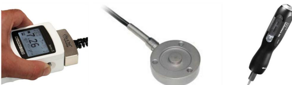
Figure V-14 : Capteur de compression Mark10 et tournevis dynamométrique FACOM utilisés
