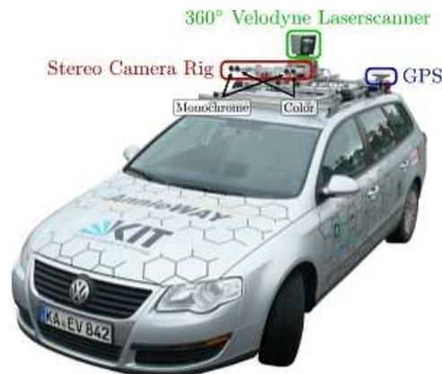
FIGURE 6.11 – Plate-forme support des acquisitions. Illustration tirée de [Geiger et al., 2012]
