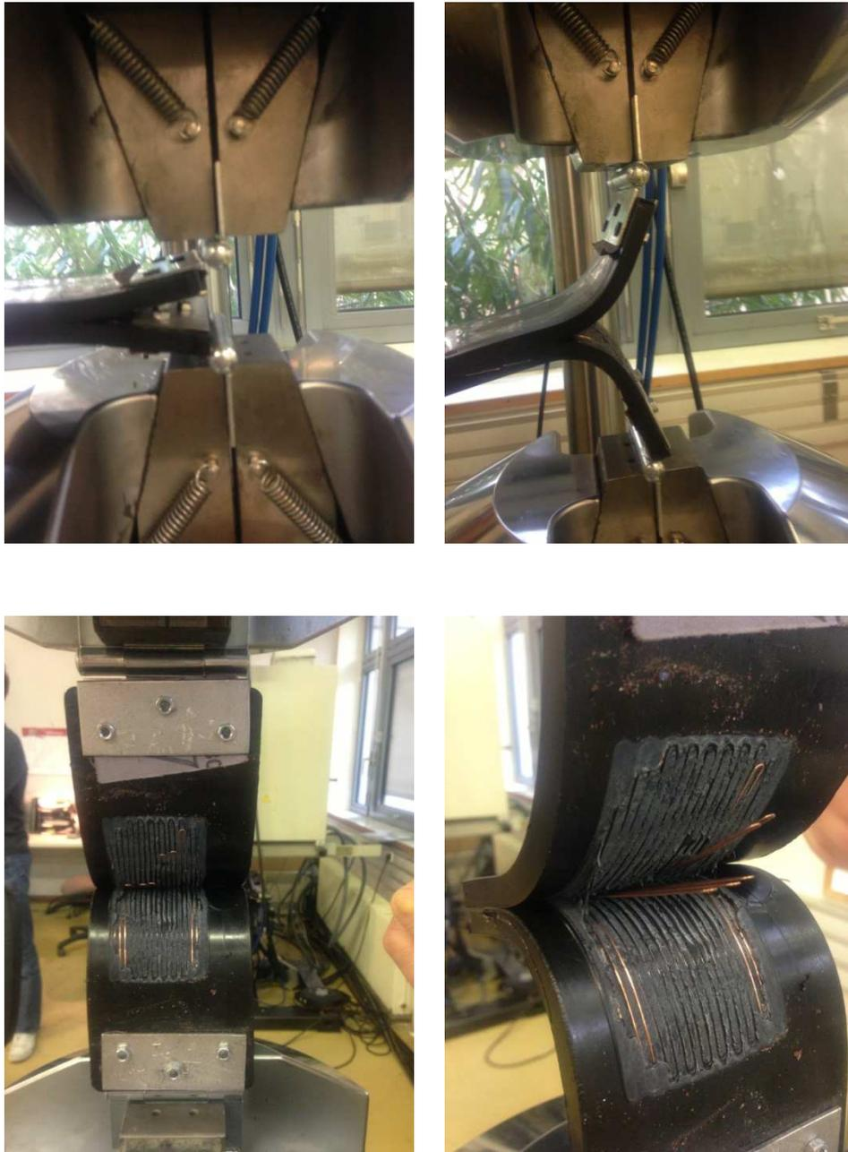
*Figure 4-52: Essai de pelage, vitesse de traction 20 mm/min à température ambiante.*
