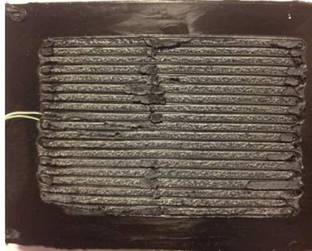
*Figure 5-10: Faciès de rupture pour un soudage supposé (numériquement) égal à 98%*
