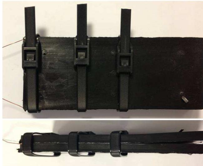
*Figure 4-18: Assemblage des plaques par l'intermédiaire de trois colliers Rilsan*
