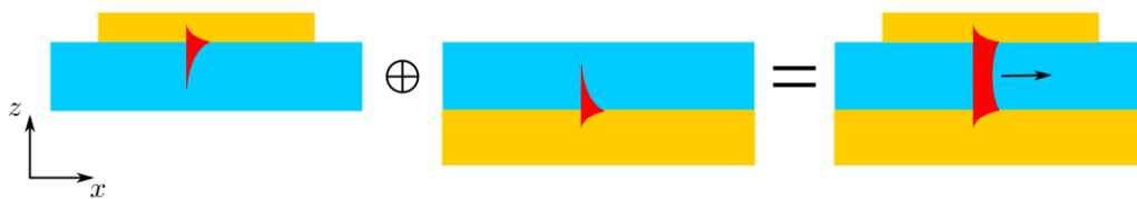
FIGURE 5.7 – Schéma du mécanisme de couplage plasmonique conduisant à l'existence d'un mode guidé dans la cavité MIM.
