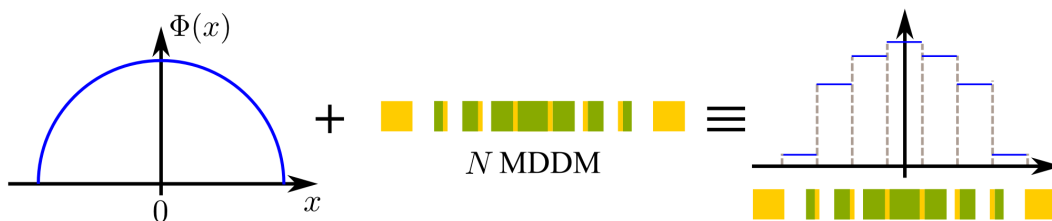
FIGURE 3.12 – Schéma illustrant l'échantillonnage spatial de la phase \Phi pour réaliser une fonction lentille à partir d'une juxtaposition de structures MDDM différenciées par leur facteur de remplissage f , leur largeur et leur hauteur étant fixées.
