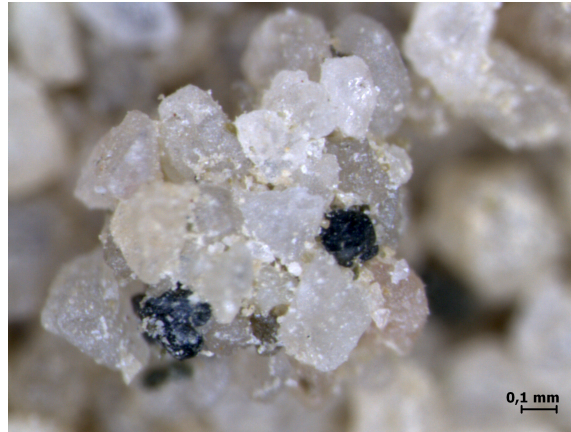
FIGURE 2.8 – Agrégation des grains de sable aptien par la fraction argileuse.
