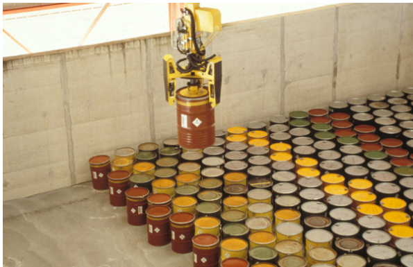
FIGURE 1.3 – Stockage de colis métalliques dans un ouvrage (Andra (2011)).
