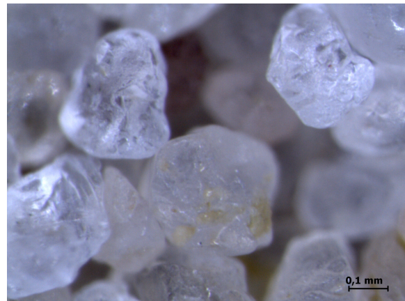
FIGURE 2.16 – Détail d'un grain de quartz au stéréomicroscope.
