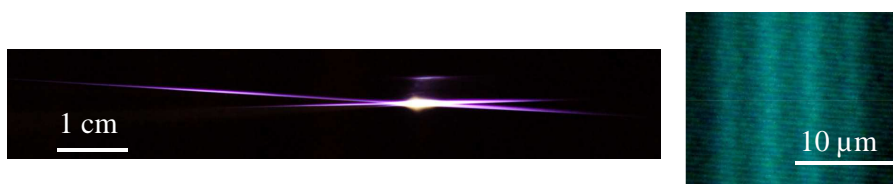
FIGURE 4.1: A gauche : Photographie de l'interaction de deux filaments dans l'air en coïncidence temporelle pour un angle \varphi = 10^\circ . A droite : Photographie du réseau de plasma situé à l'intersection des deux filaments.
