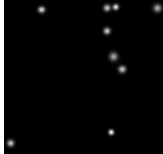
Figure 5-23 : Simulation de nanoparticules sphériques imagées par MEB. La largeur et la longueur de l'image simulée est fixée à 2 \mu\text{m} avec une taille de pixel égale à 1 nm.
