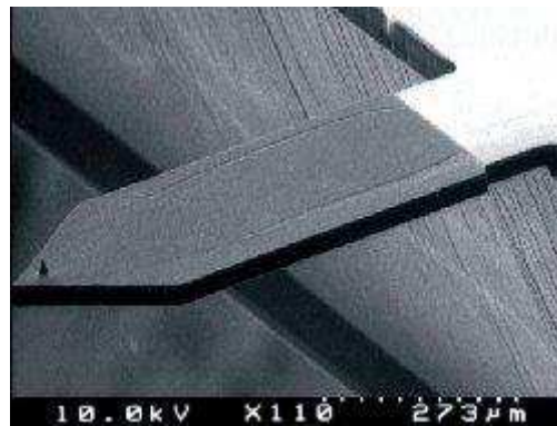
Figure 1-14 : Image MEB d'une pointe AFM sur son levier. Pointes standards commercialisées par Nanoandmore a
