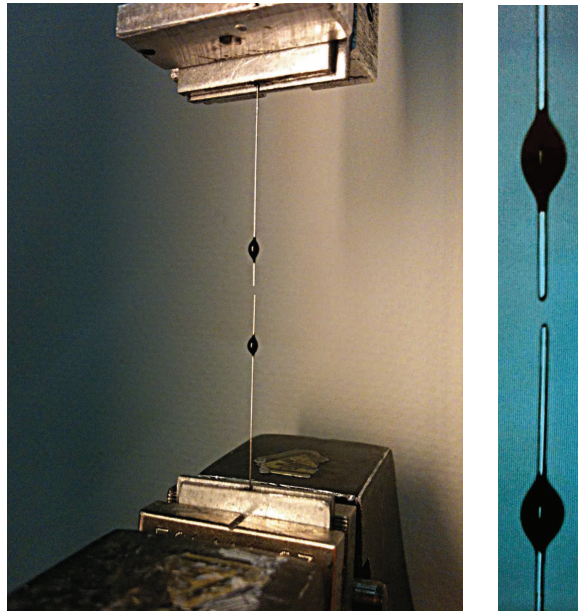
Figure 2-2 : Marquage des brins à l'encre pour le suivi par vidéotraction®.
