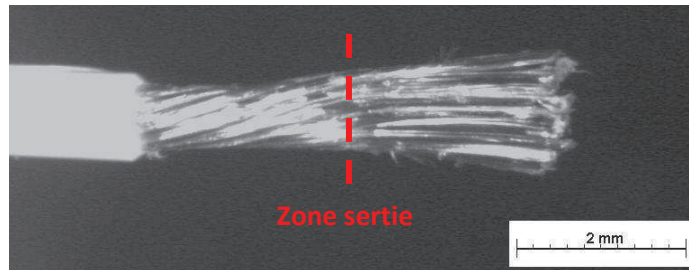
Figure 3-36 : Mise en évidence du détorsadage des brins après traction du contact sertis.
