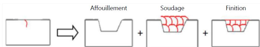
FIGURE I.1.7 – Procédé de réparation d'une pièce
