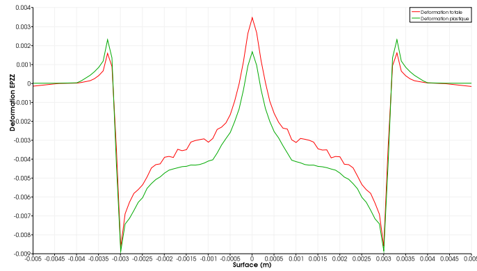
FIGURE IV.2.19 – Comparaison des déformations totale et plastique à la surface
