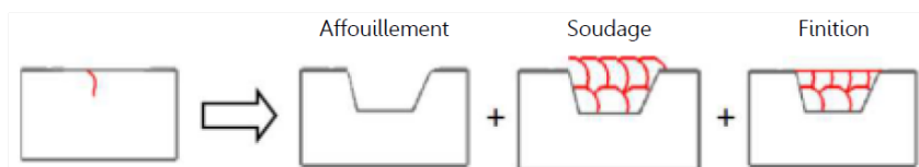
FIGURE I.1.7 – Procédé de réparation d'une pièce
