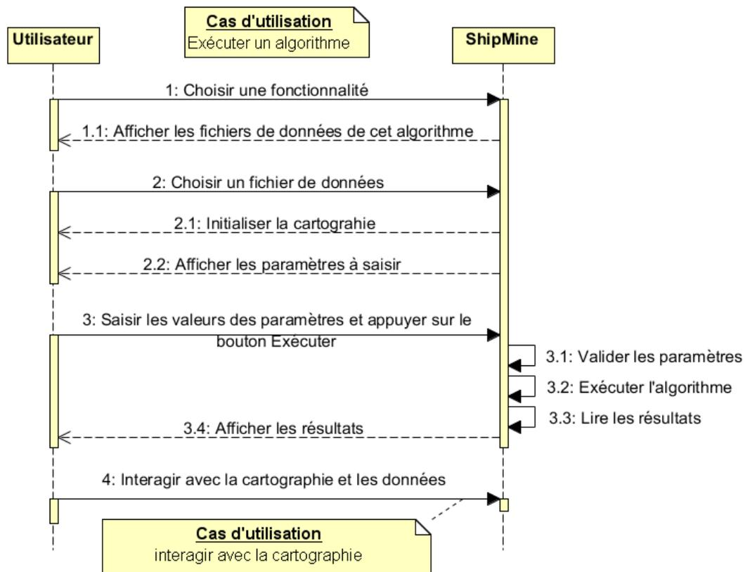
Figure 3-6 : Diagramme de séquence des interactions au cours de l'exécution d'un algorithme.
