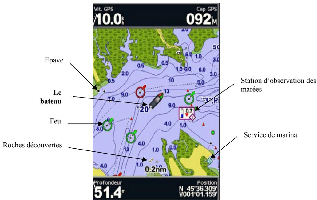
Figure 0-3 : Capture écran de l'interface d'un système d'aide à la navigation (source Garmin<sup>17</sup>).
