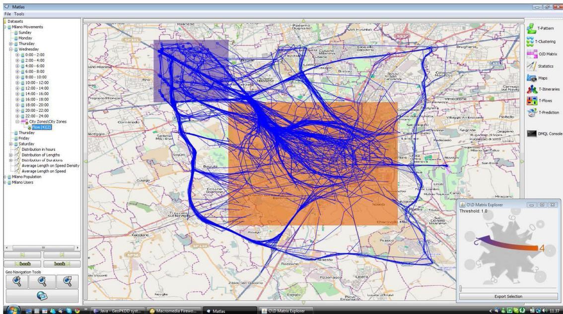
Figure 2-36 : Interface M-Atlas du résultat de T-Pattern entre le centre-ville (couleur orange) et le nord-ouest. La petite fenêtre à droite est la matrice de transition T-O/DMatrix (Giannotti et al., 2011).
