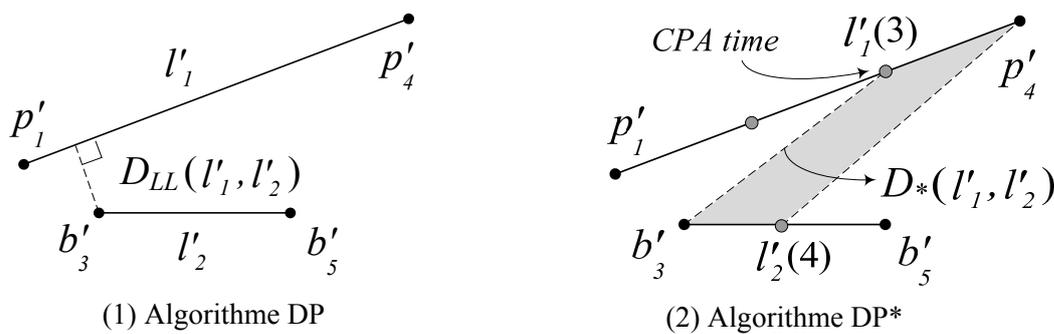
Figure 2-23 : Différence entre le calcul de distance des algorithmes DP et DP\*. Dans (1) une distance perpendiculaire est calculée et dans (2) une distance entre 2 positions ayant le même timestamp (Jeung et al., 2008a).
