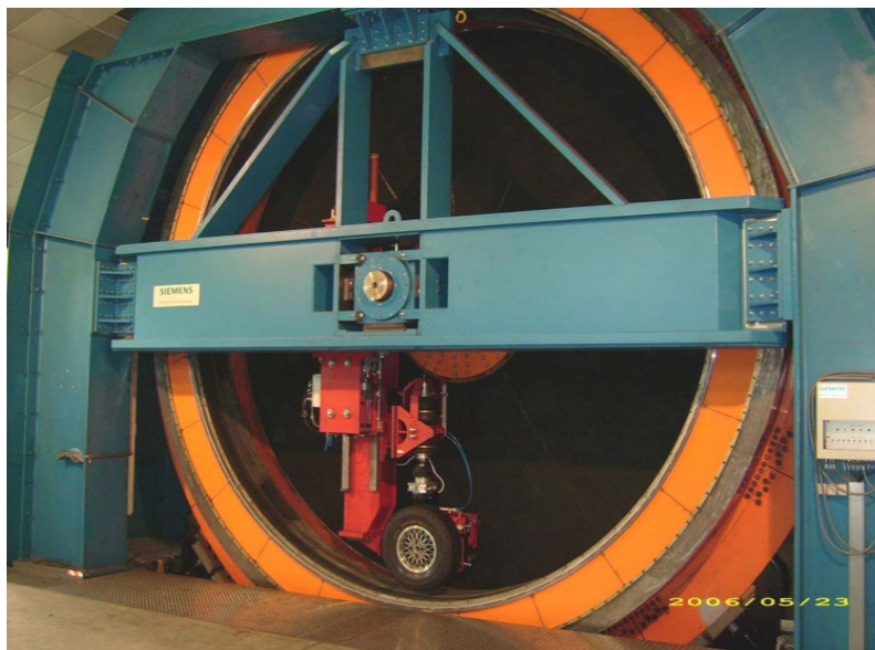
FIGURE 1.2 – Moyen de mesure de la résistance au roulement en laboratoire : rouleuse à volant interne de la BAST en Allemagne [51].
