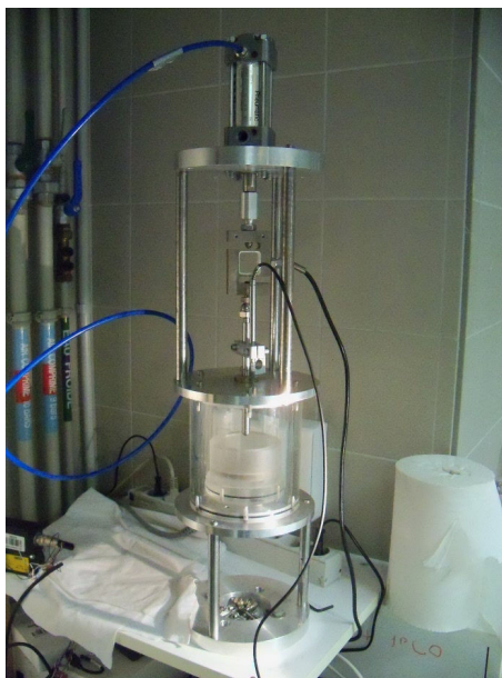
FIGURE 7.4 – Cellule œdométrique et systèmes de chargement et d’apport d’eau développés
