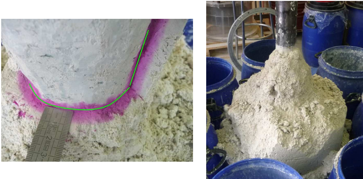
Figure III-26 - Zone d'interface entre la colonne et le sol environnant
