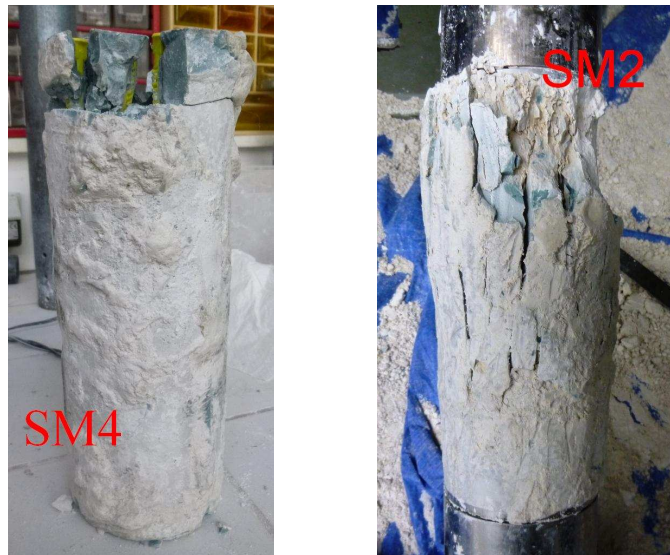
Figure III-23 - Tronçon récupéré à la fin de l'essai : (a) Rc à 28 jours ; (b) Rc à 7 jours
