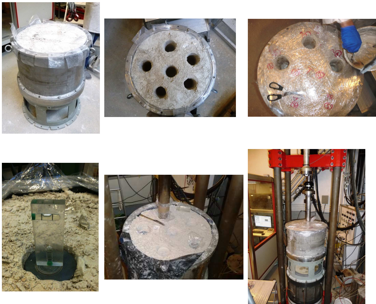
Figure IV-7 - Procédure de mise en place des colonnes au jeune âge
