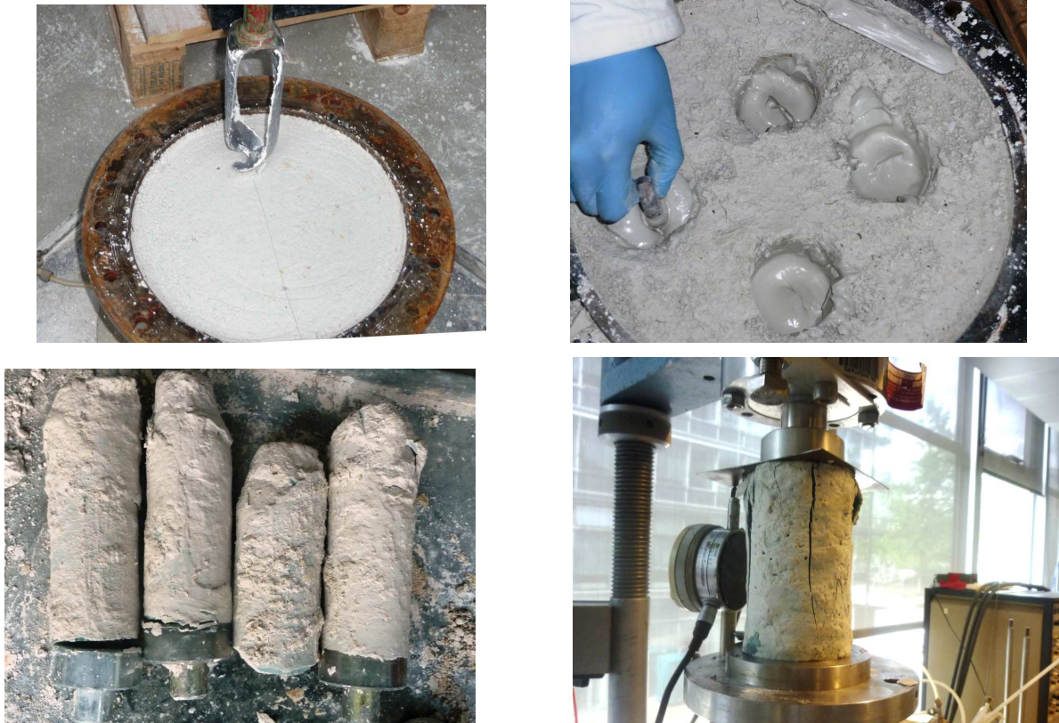
Figure II-33 - Procédure de réalisation des éprouvettes de soil-mix de 60 mm de diamètre dans un massif de sol de 30 cm de diamètre
