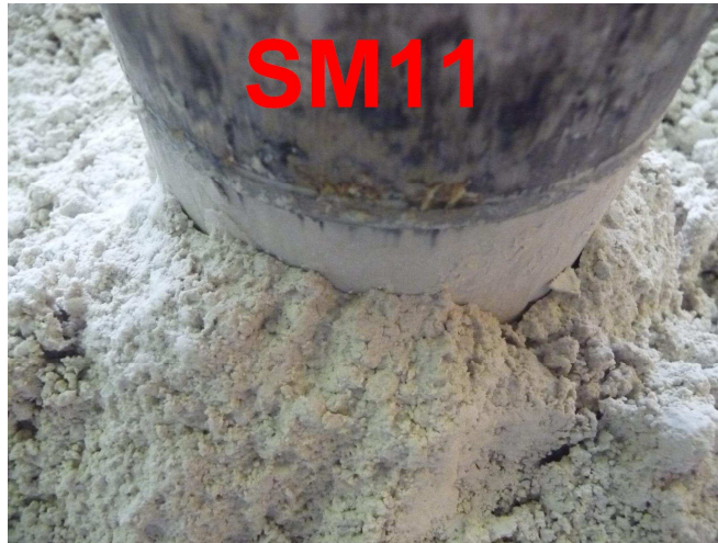
Figure III-37 – Vue de l'interface sol-colonne au démontage (essai SM11, \delta = 800\mu\text{m} )
