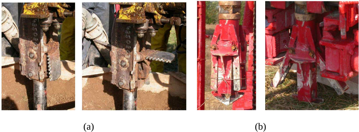
Figure I-5 - Outils de malaxage dans le cas du projet INNOTRACK : (a) outil développé par Keller-Fondation ; (b) outil développé par Soletanche Bachy (INNOTRACK, 2009)
