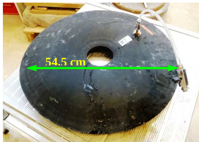
Figure II-5 - Boudruche de pressurisation verticale
