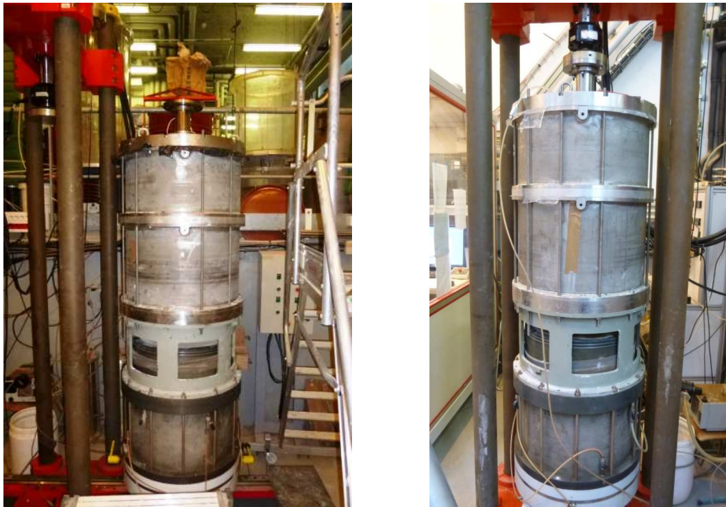
Figure II-47 – Vues de l’ensemble du dispositif expérimental : (a) mise en place sur le socle support, mobile en translation et rotation ; (b) ajustement du dispositif sous le servovérin.
