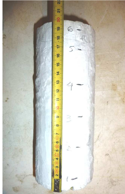
Figure III-19 - Profil géométrique de la colonne après l'essai – cas du massif SM10
