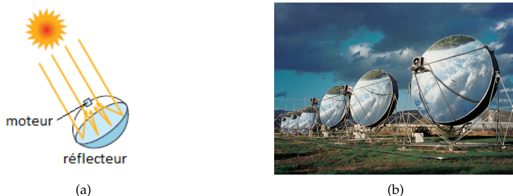
FIGURE 1.12 – (a) Schéma de principe d'un système de concentration Dish Stirling. (b) Photographie de plusieurs concentrateurs Dish Stirling.
