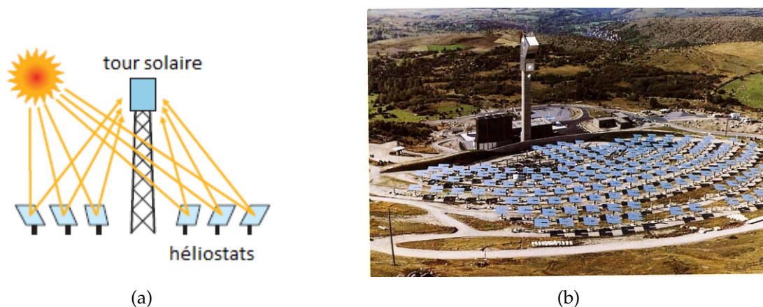
FIGURE 1.13 – (a) Schéma de principe d'un système CSP à tour solaire. (b) Photographie de la centrale Themis, située à Targassonne dans les Pyrénées-Orientales.
