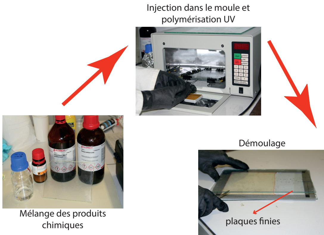
FIGURE 2.3 – Procédé de fabrication par photopolymérisation des plaques d'acrylate dans un four à UV à partir du mélange des produits chimiques bruts injecté dans un moule en verre.
