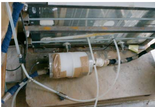
(d) Relative humidity and temperature measurement unit
