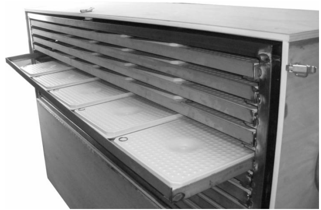
Figure 4. 4: Photographie de l'échangeur-stockeur fabriqué pour la maison Sumbiosi
