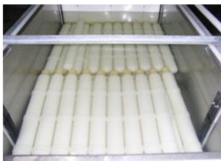
Figure 2. 9 : Photographie d'un échangeur rempli de TubeICE de PCM products (PCM Products, 2013)
