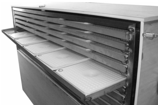
Figure 4. 18: Photographie de l'échangeur-stockeur fabriqué pour la maison SUMBIOSI en position horizontale
