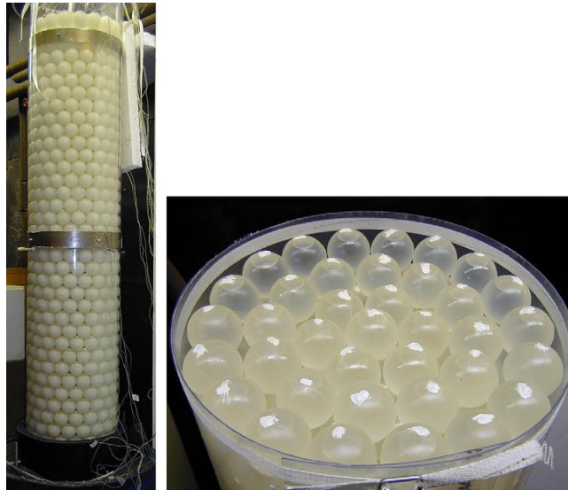
Figure 2. 6 : Photographies du prototype d'échangeur-stockeur propose par Arkar et al. (Arkar et al., 2007)
