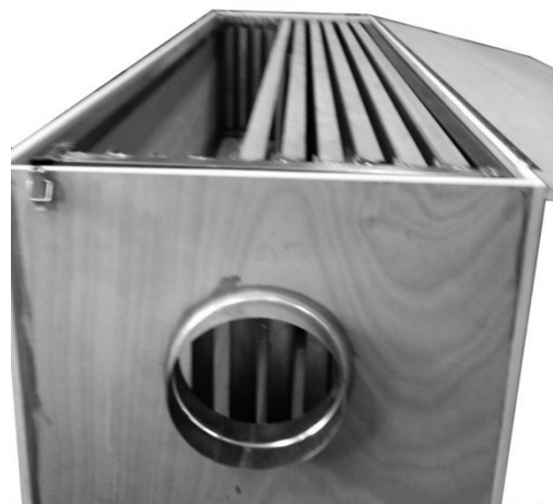
Figure 4. 19: Photographie de l'échangeur-stockeur fabriqué pour la maison SUMBIOSI en position verticale
