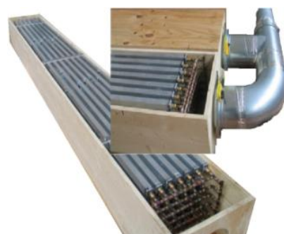
Figure 2. 10 : Photographie de l'échangeur-stockeur conçu et fabriqué par (Ekomy Ango, 2011)
