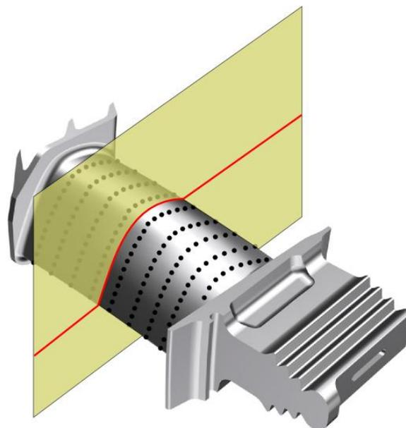
Caractérisation des aubes de turbine par section.
