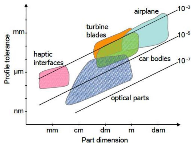
Tolérance en fonction de la dimension des surfaces complexes et freeform [22].
