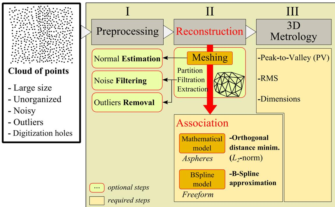
Procédure de traitement des données mesurées d'une surface complexe.
