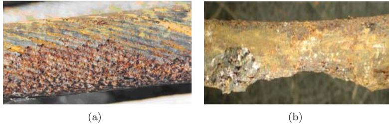
FIG. 3.13 – Endommagements liés à la corrosion
