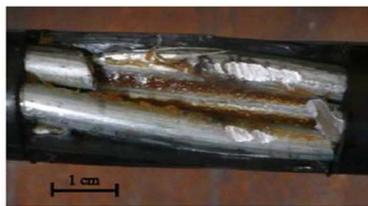
FIG. 3.14 – Rupture d'un sur sept fils d'un mono-toron
