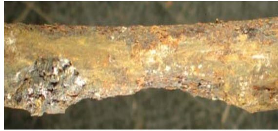
(b) Cratère de dissolution (section réduite localement de 50%)
