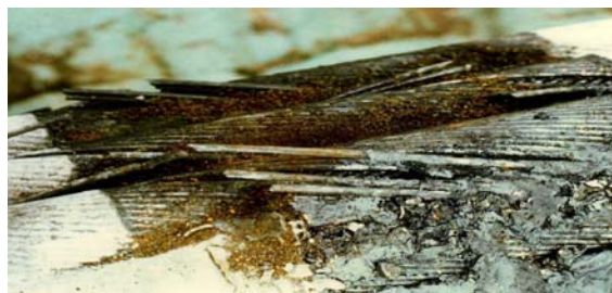
(f) Cas de fretting fatigue frottements torons / colliers
