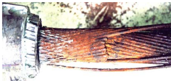
(d) Ruptures de fatigue toron multicouche
