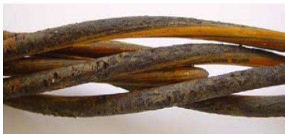
(c) Rupture par corrosion fissurante sous contrainte
