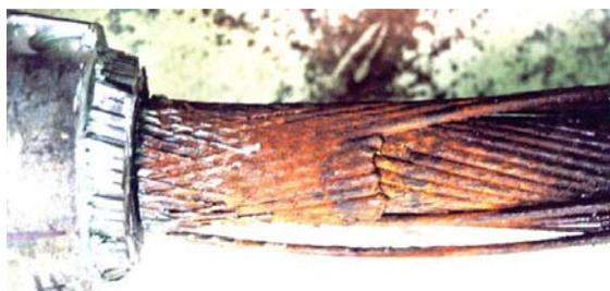
(d) Ruptures de fatigue toron multicouche
