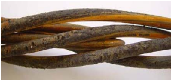
(c) Rupture par corrosion fissurante sous contrainte
