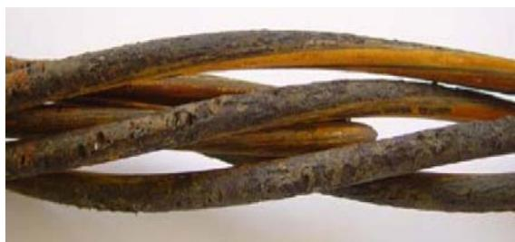
(c) Rupture par corrosion fissurante sous contrainte
