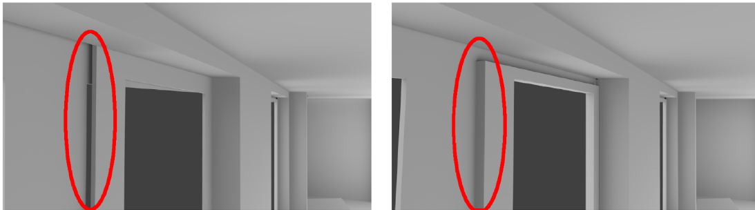
FIGURE 8.21 – Régularisation sur les coins (à gauche), et conjointement arêtes et coins (à droite).
