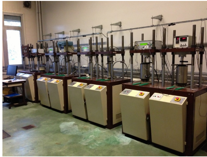
Figure 8.4. Une vue des presses triaxiales utilisées pour les essais de fluage au laboratoire.
