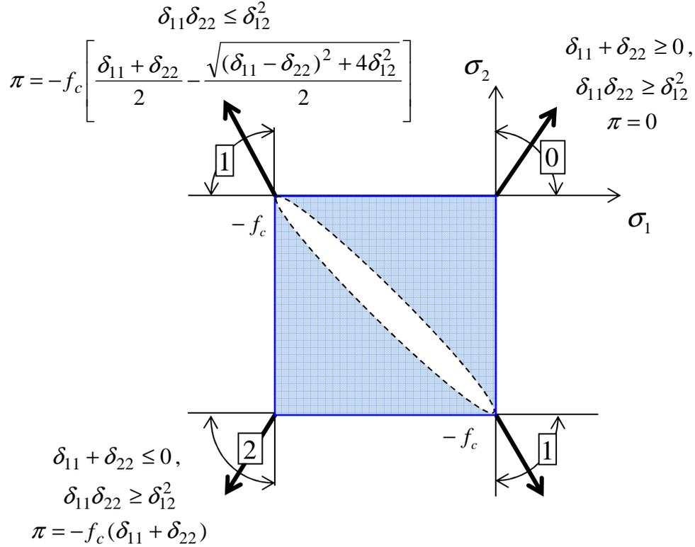
Figure 5.7. Fonction d'appui du critère de béton en contraintes planes en fonction des composantes de  $\underline{\delta}$
