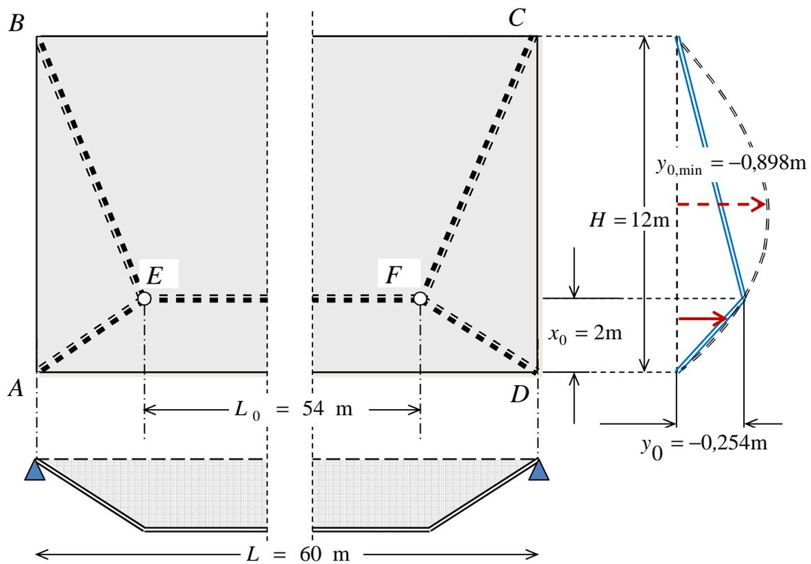
Figure 6.11. Charnières du mécanisme de ruine correspondant à la valeur minimale du facteur de stabilité obtenu sur la configuration déformée simplifiée du panneau rectangulaire  $12 \times 60 \text{ m}^2$
