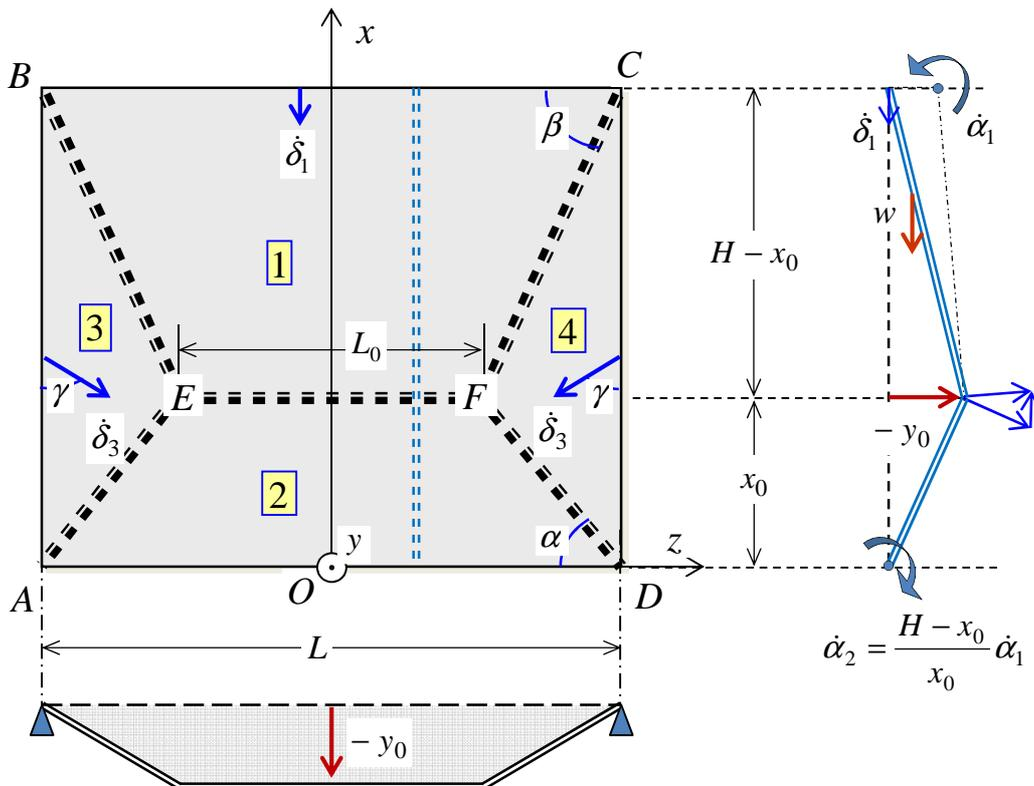
Figure 6.2. Mécanisme de ruine défini sur la configuration déformée simplifiée du panneau (mouvement virtuel avec discontinuités de vitesse de translation et de rotation le long de charnières)
