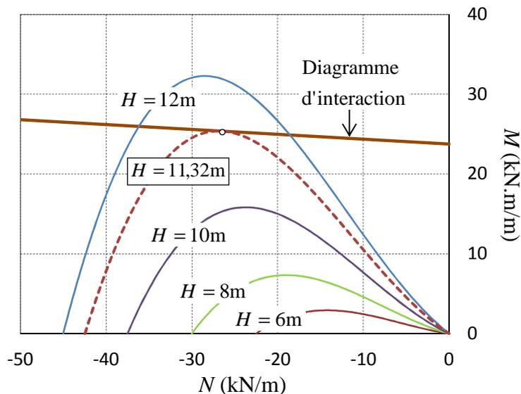
Figure 4.3. Condition de stabilité des panneaux de 6m, 8m 10m et 12m de hauteur exposés 120min au feu
