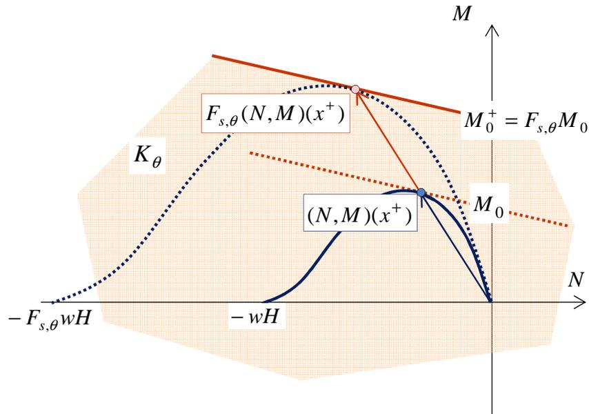
Figure 4.5. Définition du facteur de stabilité statique  $F_{s,\theta}$
