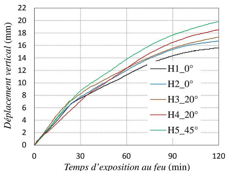
Figure 7.15. Évolution de la flèche des essais H1 à H5 au cours de l'échauffement
