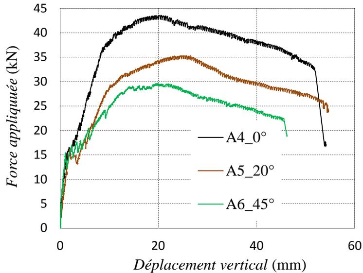
Figure 7.11. Courbes force-déplacement relatives aux essais A4, A5 et A6
