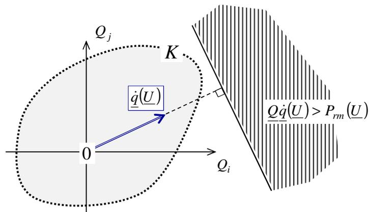
Figure 1.14. Interprétation géométrique de l'approche cinématique par l'extérieur
