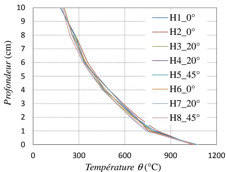
Figure 7.14. Gradients thermiques mesurés dans l'épaisseur des éprouvettes à 120 minutes
