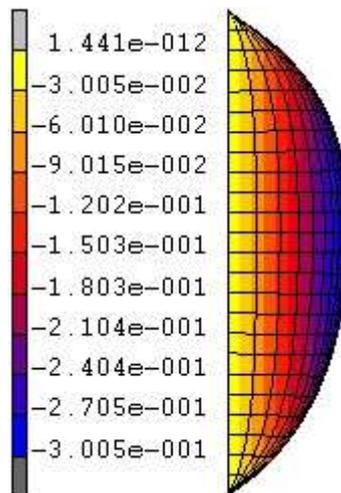
Figure 6.6. Déplacements transversaux du panneau  $12 \times 12 m^2$  dont la déformée a été agrandie 10 fois : vue latérale dans le plan  $Oxy$
