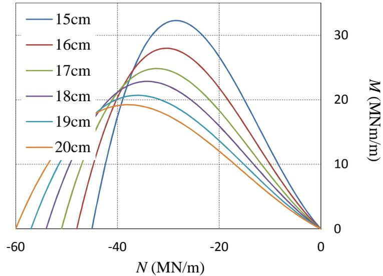
Figure 4.10. Courbes de sollicitations des panneaux de différentes épaisseurs
