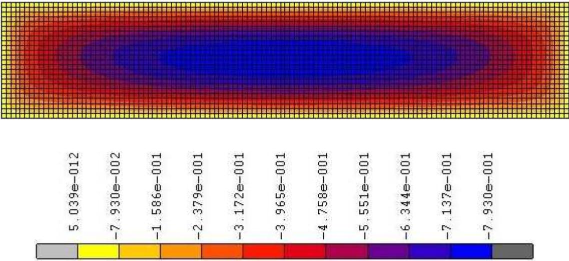
Figure 6.7. Déplacements transversaux du panneau  $12 \times 60m^2$  soumis au seul chargement thermique : vue de face dans le plan Oxy
