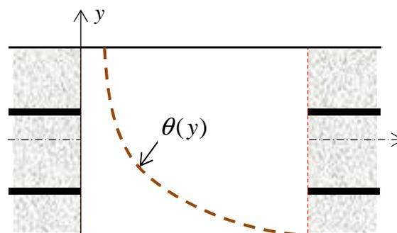
Figure 2.3. Profil de température dans l'épaisseur de la plaque
