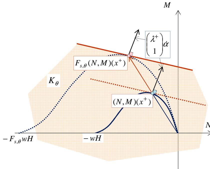
Figure 4.8. Équivalence des facteurs de stabilité statique et cinématique
