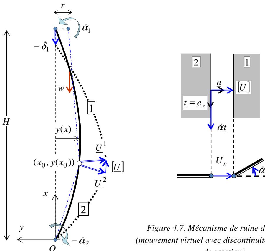
Figure 4.7. Mécanisme de ruine du panneau (mouvement virtuel avec discontinuité de vitesse et de rotation)
