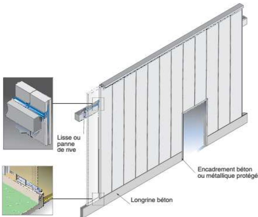
Figure 1.1. Exemple de panneaux en béton cellulaire armé en pose verticale - (CIMbéton, 2007)
