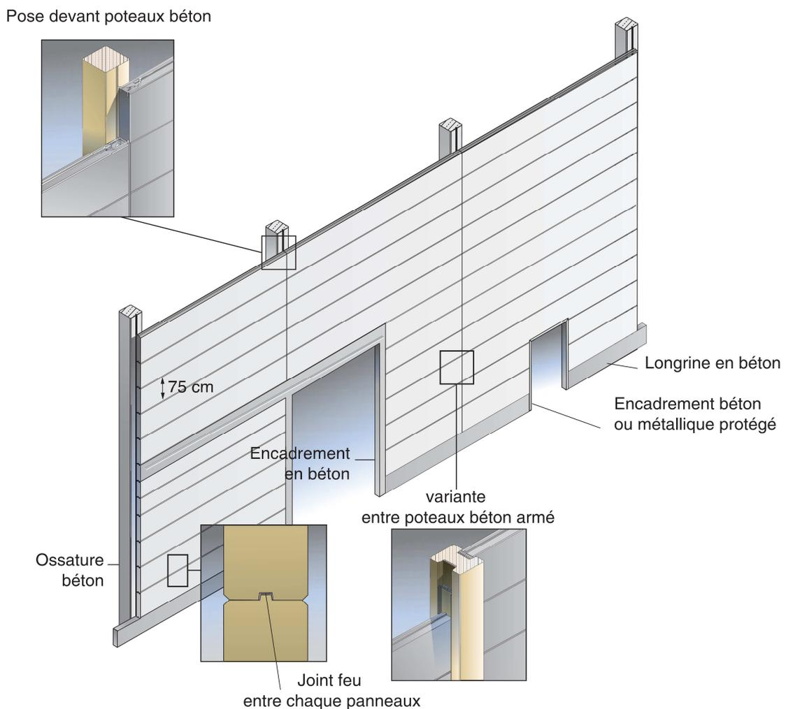
Figure 1.2. Exemple de panneaux en béton cellulaire armé en pose horizontale - (CIMbéton, 2007)
