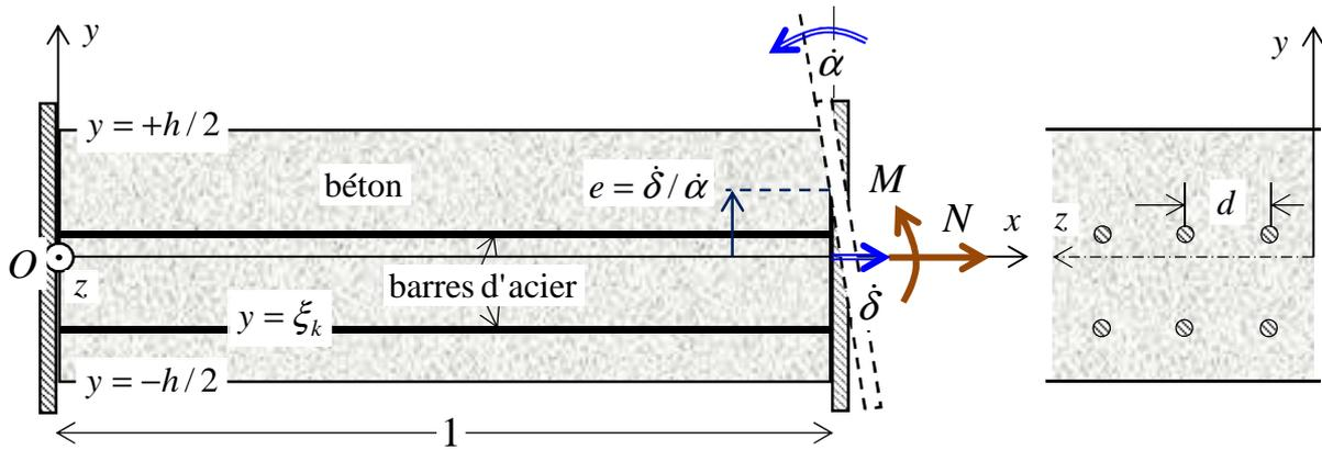
Figure 2.2. Élément de plaque en béton armé soumis à la combinaison d'un effort normal et d'un moment fléchissant
