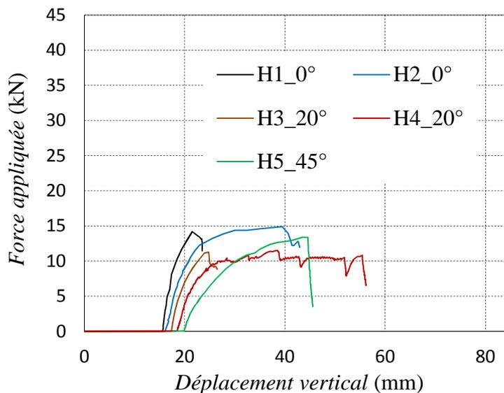
Figure 7.17. Courbes force-déplacement des essais H1 à H5
