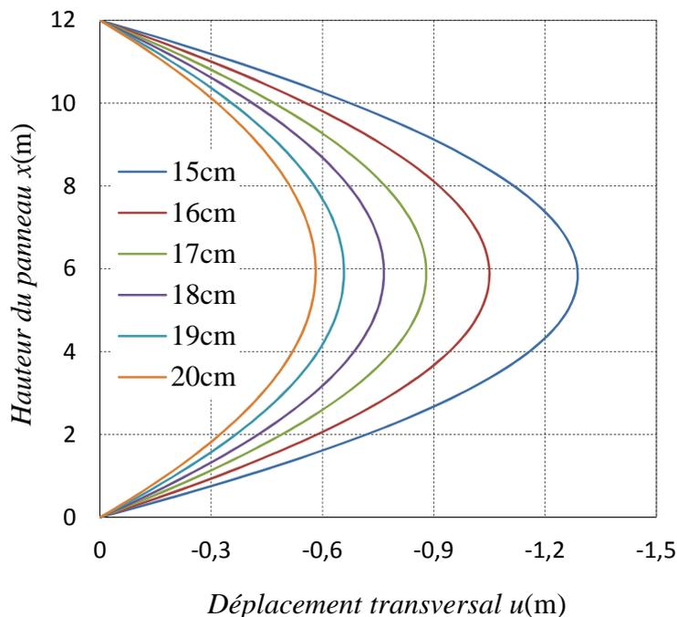
Figure 4.9. Déformées des panneaux de différentes épaisseurs
