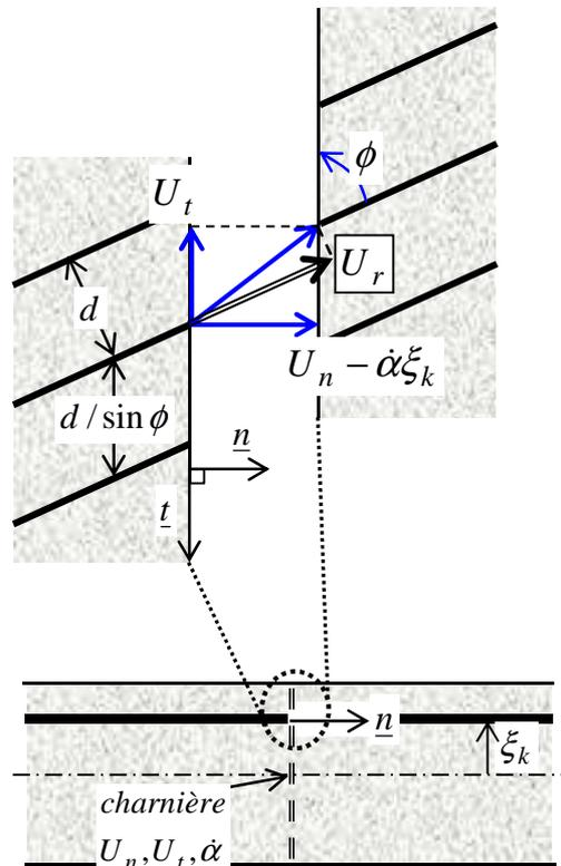
Figure 5.9. Discontinuité de vitesse dans un lit de renforcement incliné d'un angle  $\phi$  par rapport à la charnière de la plaque
