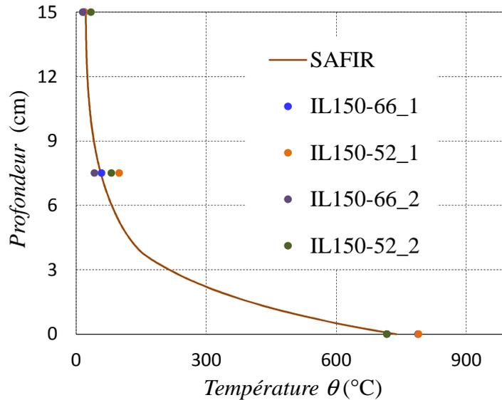
Figure 7.2. Distribution de température calculée par Safir et mesures de température des tests de Croizier et Sanjayan à 30min
