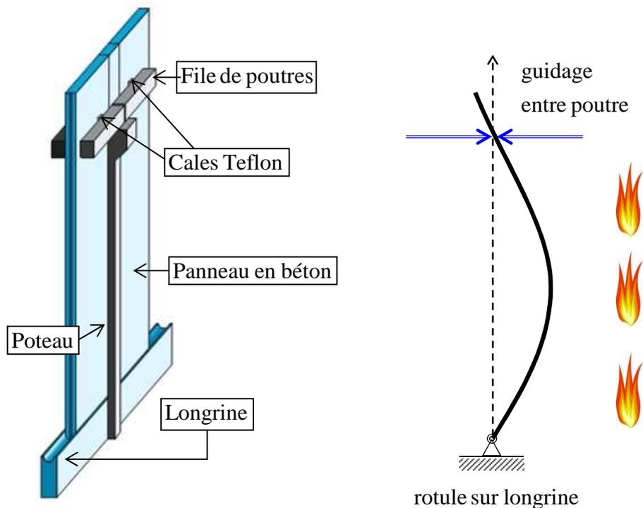
Figure 1.3. Concept d'un système de panneaux précontraints « rotulés » et principe de fonctionnement au feu-(CIMbéton, 2007)
