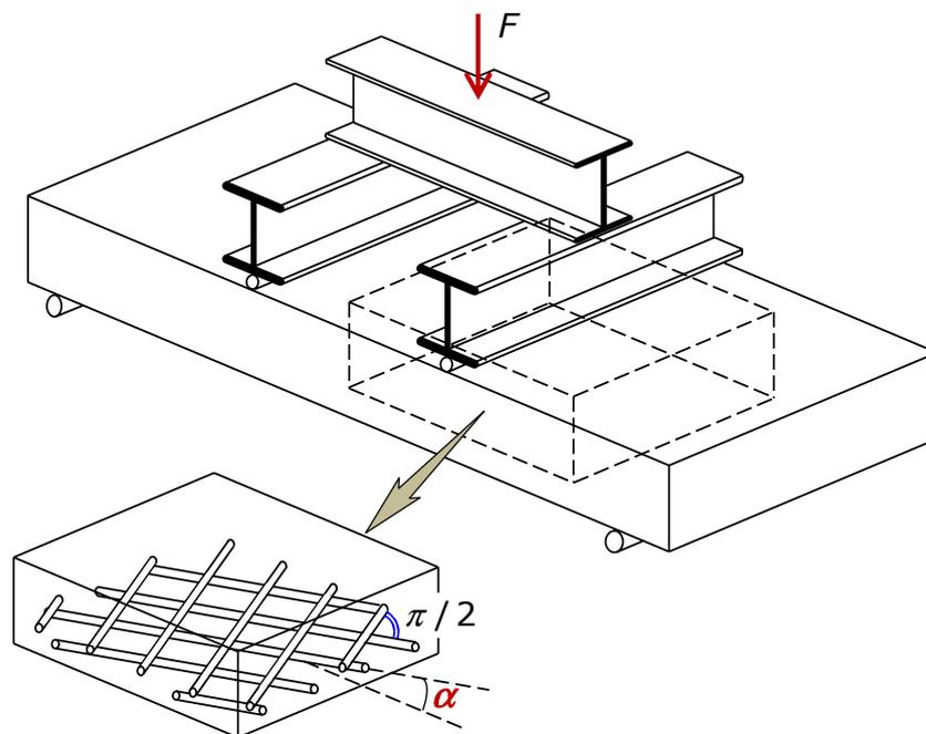
Figure 7.8. Configuration d'un test de flexion 4 points
