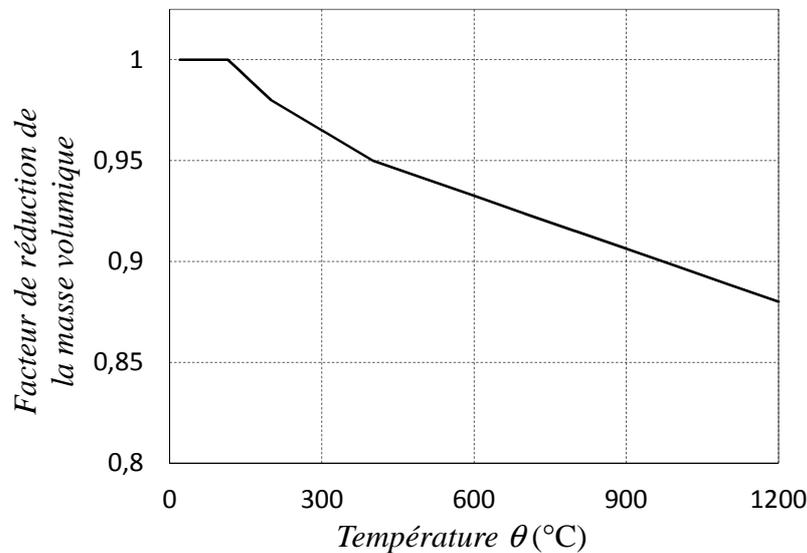
Figure 1.7. Évolution de la masse volumique du béton en fonction de la température
