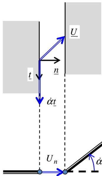
Figure 5.8. Saut de vitesse et de taux de rotation à la traversée d'une ligne de discontinuité (charnière)
