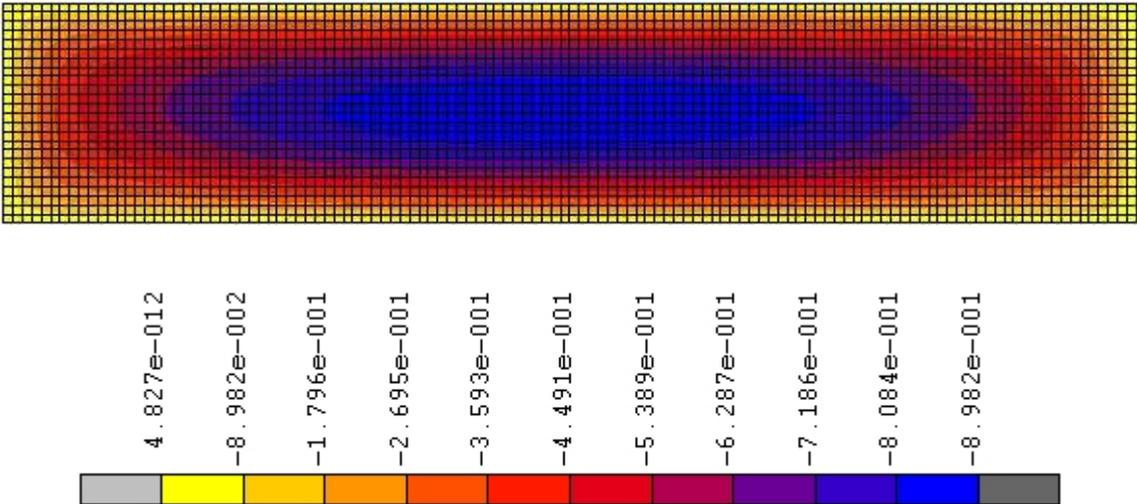
Figure 6.8. Déplacements transversaux du panneau  $12 \times 60m^2$  : vue de face dans le plan Oxy
