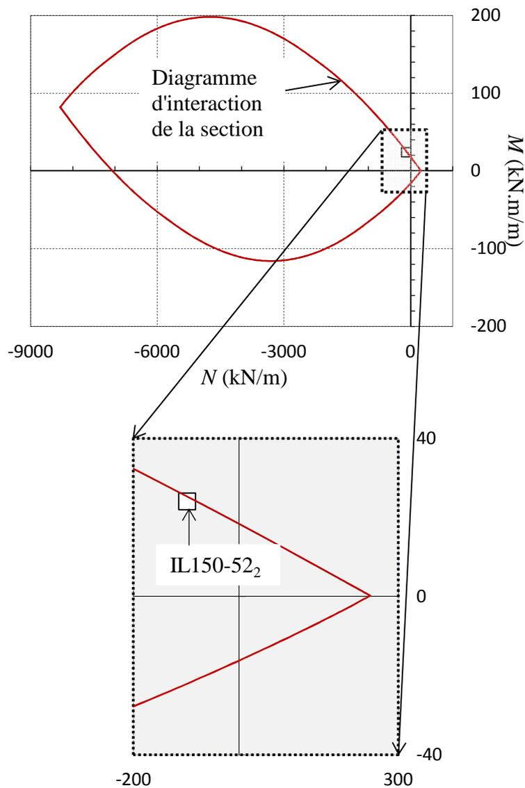
Figure 7.5. Comparaison du diagramme d'interaction calculé avec le résultat du test IL150-52<sub>2</sub> effectué par Crozier et Sanjayan
