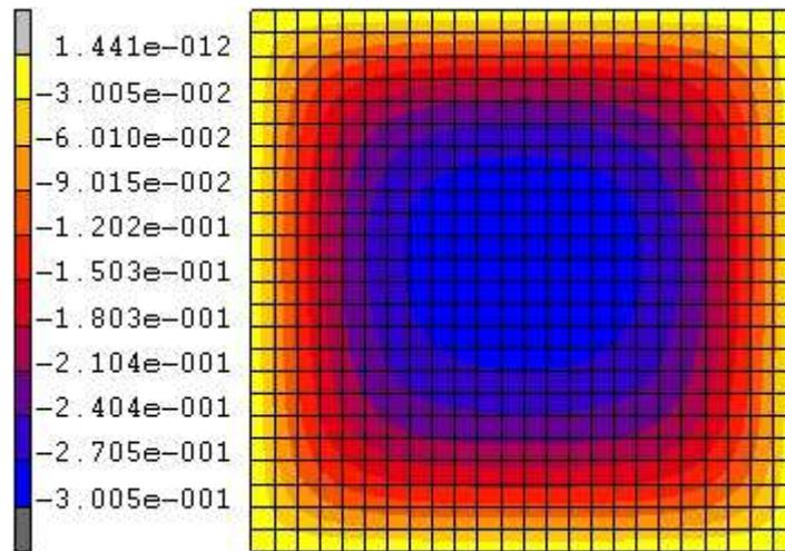
Figure 6.5. Iso-valeurs des déplacements transversaux du panneau  $12 \times 12 m^2$  : vue de face dans le plan  $Oxz$
