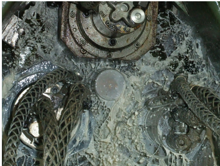
(b) Opération de fluotournage industriel, montrant l'importance de la lubrification.
