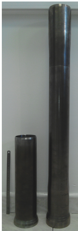
FIGURE 2.18 – Photographie du tube fluotourné deux fois, avec recuit \alpha - \beta intermédiaire (à droite). À titre de comparaison, un tube fluotourné une fois a été mis sur la photographie.
