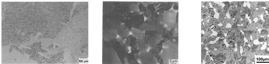
(a) Structure lamellaire [SESHACHARYULU et collab., 2000a] (b) Structure équiaxe [FOLLANSBEE et GRAY, 1989] (c) Structure bimodale [LÜTJERING et WILLIAMS, 2007]
