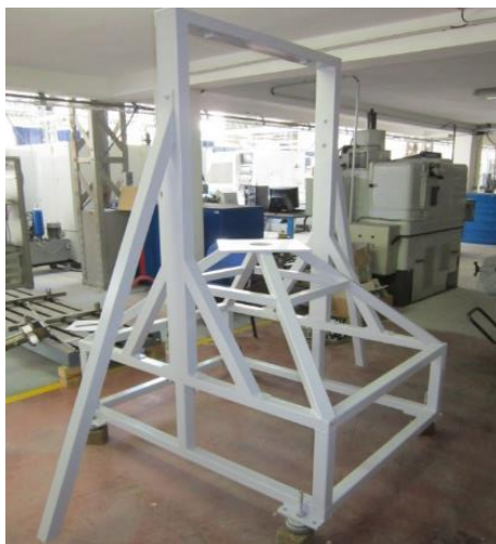
Figure 5.35 – Photo du bâti isolé du banc d'essai ENSAM
