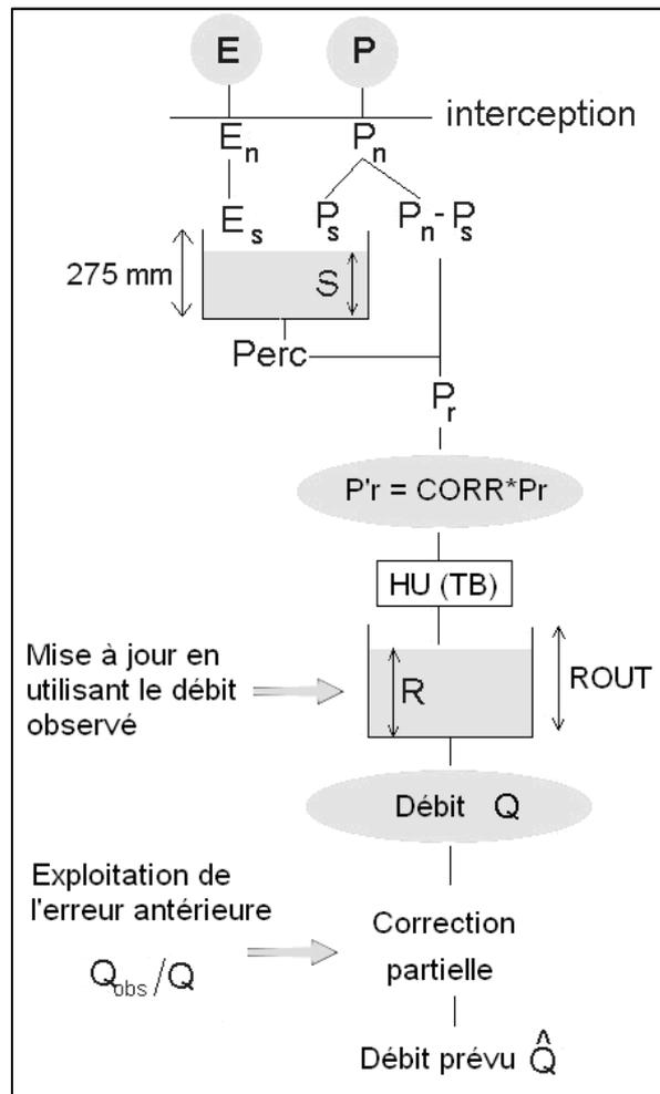
Figure 69 : Schéma structurel du modèle GRP
