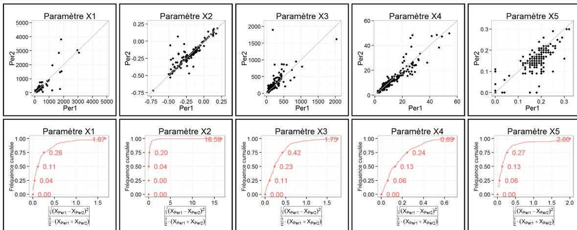
**Figure 20 : Résultat de l'optimisation des cinq paramètres du modèle global GR5H sur 181 bassins versants : (haut) comparaison des paramètres optimisés sur la période 1 (Per1 : 1997-2001) et la période 2 (Per2 : 2002-2006) ; (bas) distribution des distances euclidiennes normalisées des paramètres entre chaque période.**
