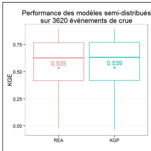
**Figure 63 : Distribution des performances en validation du modèle semi-distribué pluie-débit avec un forçage des précipitations estimées par la réanalyse (REA) ou le krigeage des pluviomètres (KGP). Les performances sont évaluées par le critère KGE sur 3620 événements de crue sélectionnés sur l'échantillon de 181 bassins**
