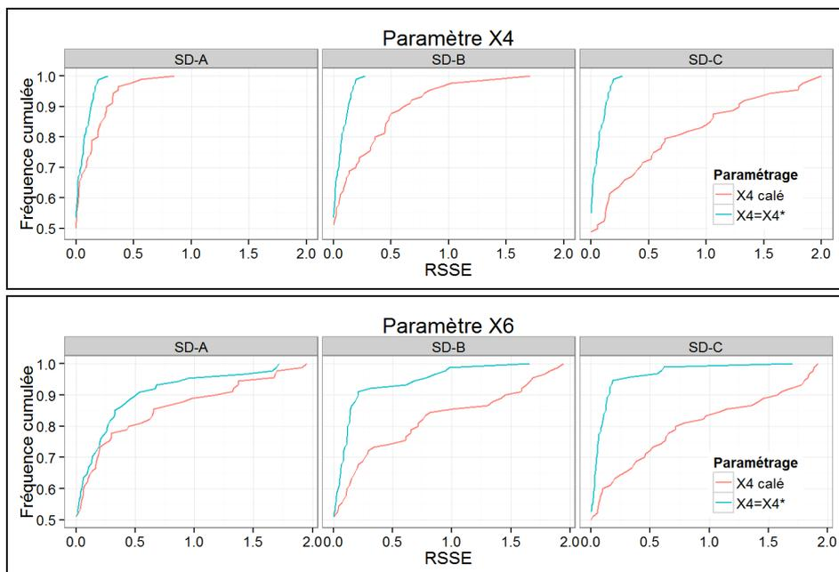
Figure 89 : Distribution du critère de robustesse  $RSSE$  des paramètres  $X_4$  et  $X_6$  du modèle semi-distribué M2 optimisés pour quatre maillages (Global, SD-A, SD-B, SD-C) et pour 45 bassins versants : ( $X_4$  calé) le paramètre  $X_4$  est calé à chaque changement de maillage ; ( $X_4=X_4^*$ ) le paramètre  $X_4^*$  est calé dans la configuration globale uniquement.
