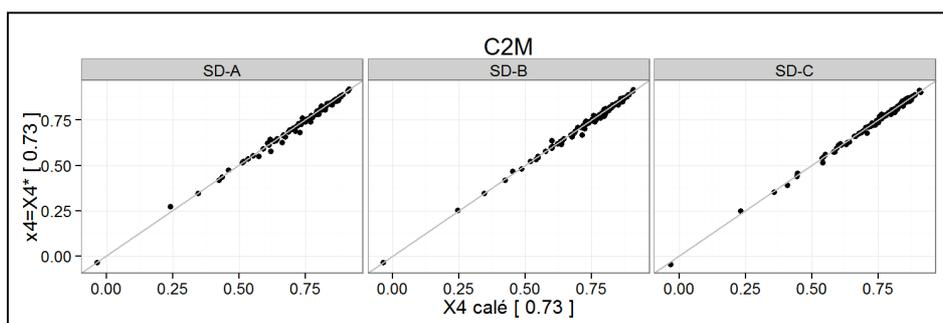
Figure 90 : Performances sur 45 bassins versants du modèle semi-distribué M2 pour quatre maillages (Global, SD-A, SD-B, SD-C) et deux méthodes de paramétrage : ( $X_4$  calé) le paramètre  $X_4$  est calé à chaque changement de maillage ; ( $X_4=X_4^*$ ) le paramètre  $X_4^*$  est calé dans la configuration globale uniquement.
