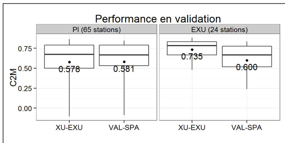
Figure 36 : Performances en validation calculées pour deux stratégies de paramétrage uniforme (XU-EXU, VAL-SPA) du modèle semi-distribué M2 avec le maillage C sur les bassins versants qui contiennent au moins deux stations de jaugeage à l'intérieur du bassin, soient 24 bassins versants (EXU) et 65 points intérieurs (PI).
