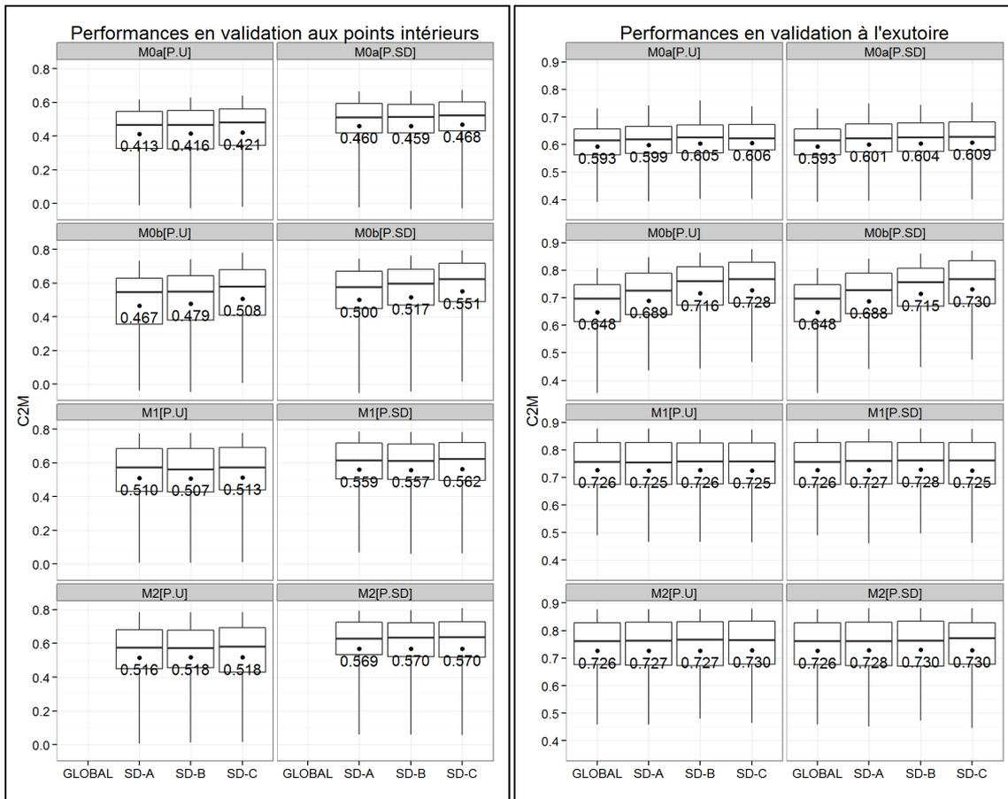
**Figure 30 : Performances en validation des quatre modèles semi-distribués testés (M0a, M0b, M1, M2) obtenus sur 86 points intérieurs (gauche) et à l'exutoire de 45 bassins versants (droite) pour quatre maillages différents (GLOBAL, SD-A, SD-B, SD-C) avec un forçage des précipitations uniforme (P.U) et distribué sur les sous-bassins (P.D).**
