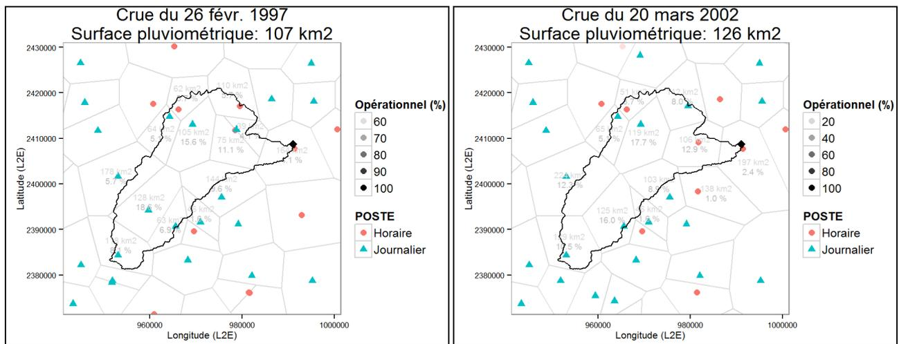
Figure 55 : Réseau de mesure pluviométrique opérationnel sur le bassin versant de la Bruche à Holtzheim (A2860110, 676 km<sup>2</sup>) pour l'échantillonnage de deux événements de crue survenus le 26 février 1997 (gauche) et le 20 mars 2002 (droite). La surface du polygone de Thiessen (en km<sup>2</sup>) et le pourcentage d'occupation du bassin sont indiqués dans chaque polygone qui intersecte le bassin versant.
