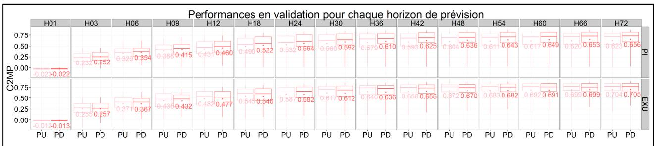
**Figure 71 : Distribution des performances en validation du modèle de prévision semi-distribué TGR sur 86 points intérieurs (PI) et 45 exutoires des bassins versants (EXU) pour chaque horizon de prévision (H01 à H72) pour des entrées de précipitation uniformes (PU) et spatialisées (PD)**
