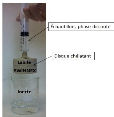
Figure 39. Montage de la spéciation par disque chélatant
