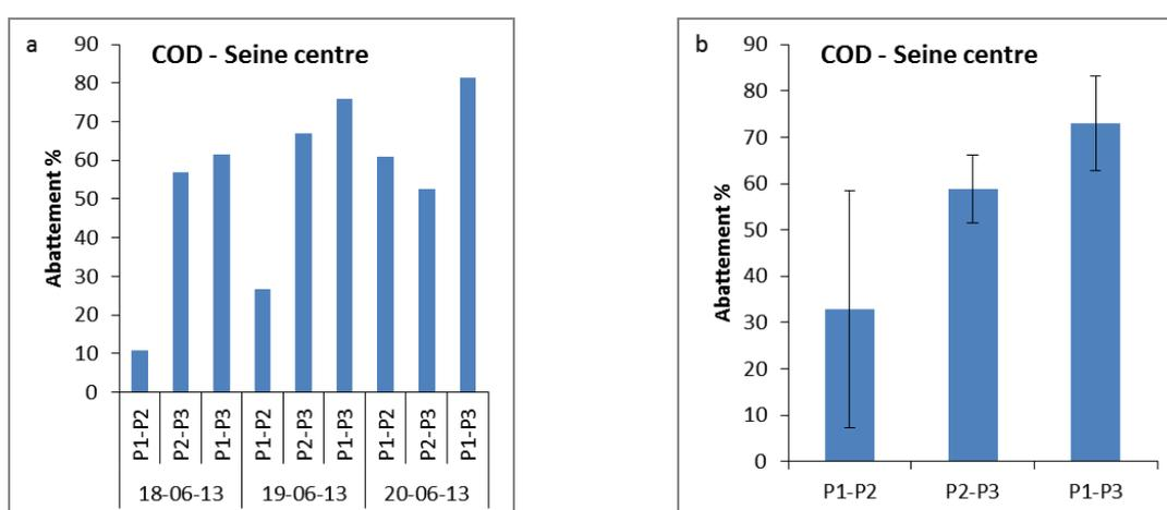
Figure 126. Abattement de la MOD au niveau du traitement primaire (P1-P2), traitement secondaire (P2-P3) et à l'échelle de la STEP Seine Centre (P1-P3)
