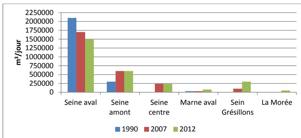
Figure 26. Évolution des capacités des stations d'épuration sur la période 1990-2012 (m<sup>3</sup>/jour)
