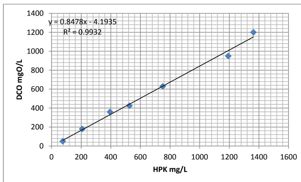
Figure 53. Droite d'étalonnage pour la DCO établie à partir d'une solution d'hydrogénéphthalate de potassium (HPK) (exemple d'étalonnage effectué au PRASE)
