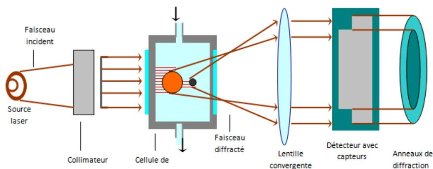
Figure 58 Schéma de fonctionnement du granulomètre Laser
