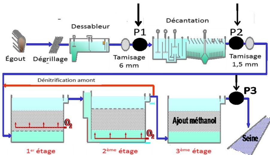
Figure 50 Points d'échantillonnage de la STEP Seine Centre
