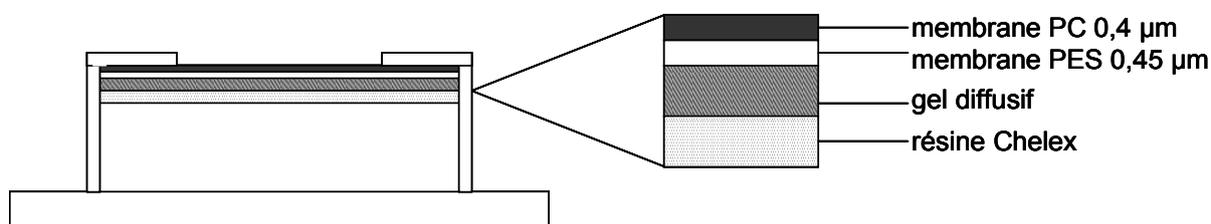
Figure 37. Schéma simplifié d'une DGT (Source Cemagref, 2011)
