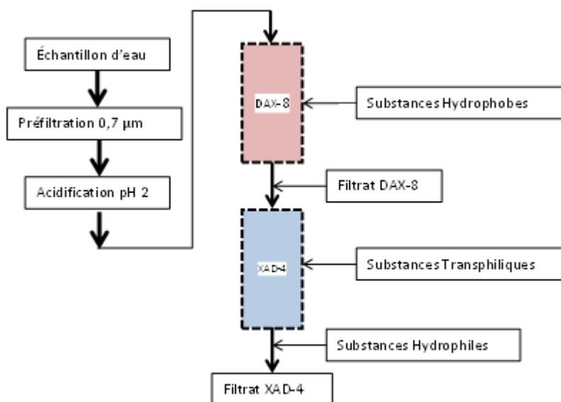
Figure 40. Montage du fractionnement de la MOD
