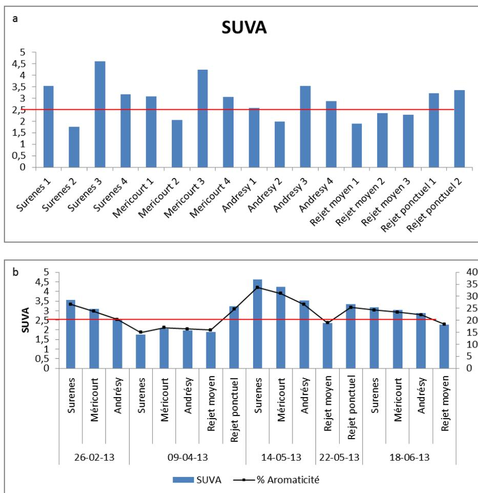
**Figure 136. SUVA et pourcentage d'aromaticité du milieu récepteur et rejet de la STEP Seine aval.**
