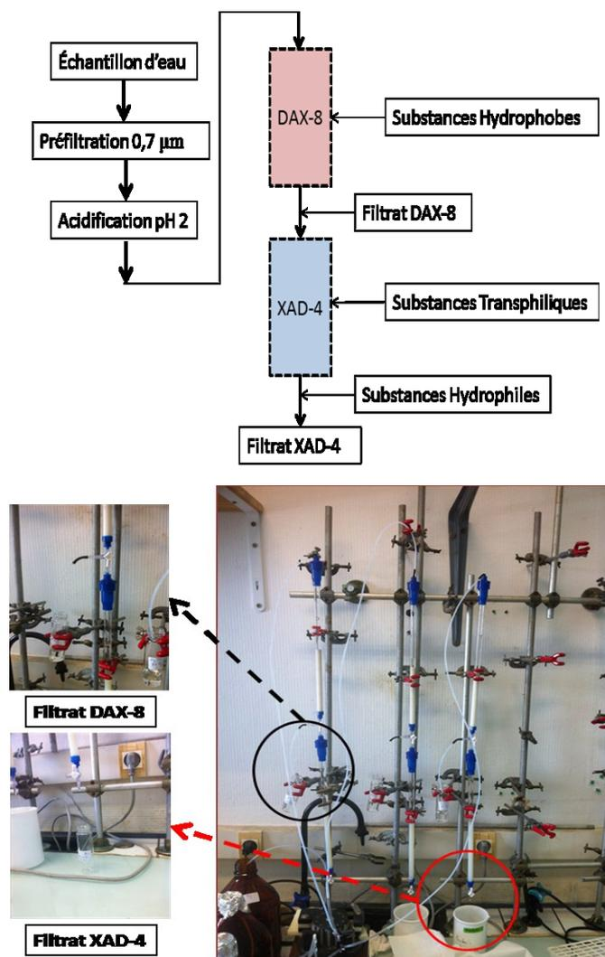
Figure 59 Montage du fractionnement de la MOD
