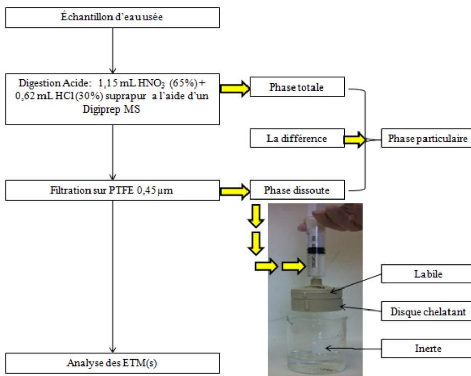
Figure 60 Démarche expérimentale pour analyser les ETM
