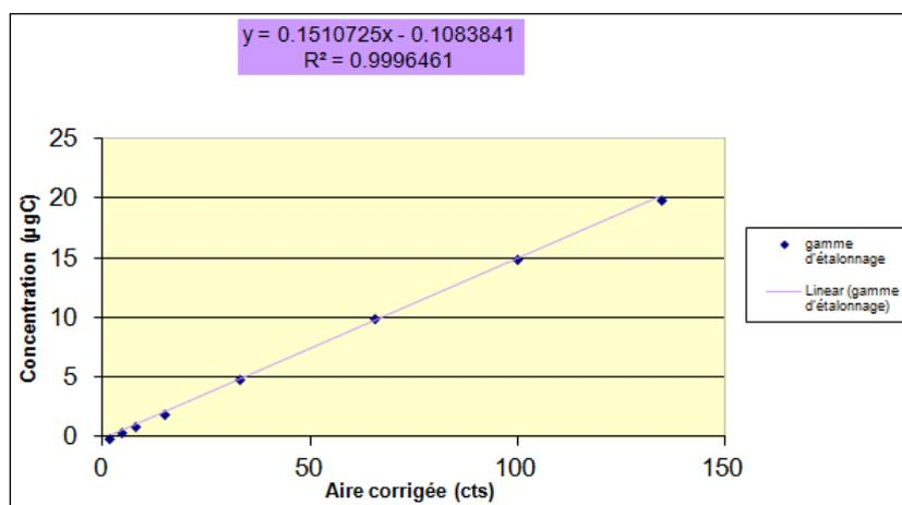
Figure 54. Courbe d'étalonnage du COD pour la gamme faible. (Effectué par SAAD au LEESU en 2013)
