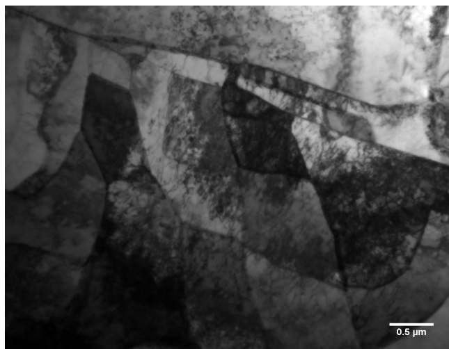
Figure 4.37 - Sous-joints dans le T40 DL ( \sigma_f=300 MPa ; \varepsilon_p=3,7 %).
