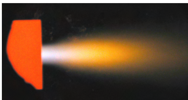
FIG. 5.23: Photographie de la tuyère et de la zone post-plasma lors du reformage ATR de l'éthanol. L = 75 mm
